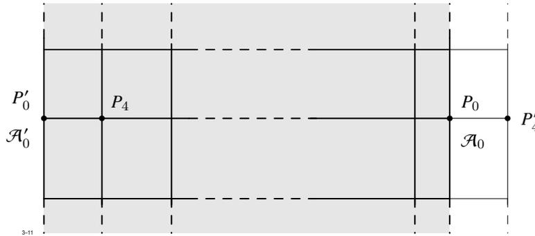
Abb. 3.20: Differenzgleichung bei periodischer Randbedingung
