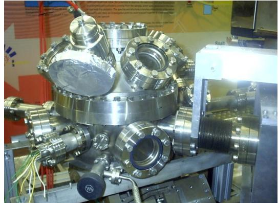
**Abb. 16: Probenkammer an einer Beamline im HASYLAB**
