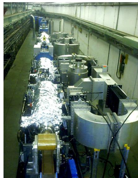
**Abb. 15: Beschleunigertunnel von DORIS III. Ganz vorne im Bild ist der Beschleunigungsring zu sehen, dahinter die von Folie geschützten Resonatoren. Ganz hinten sind die Dipolmagnete (blau) zu erkennen.**
