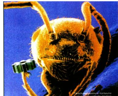
**Abb. 21: Mit Synchrotronstrahlung hergestelltes Zahnrad aus Nickel**
