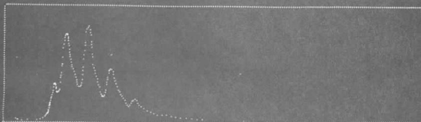
Nach der Umrechnung kann der Plotter per Programm um definierte Beträge in der X- und Y-Richtung verschoben werden. Damit können zum Beispiel mehrere Kurven aneinandergesetzt werden (wenn die Punktzahl zusammen mehr als 900 beträgt), es können Nullpunkte verschoben werden etc.
