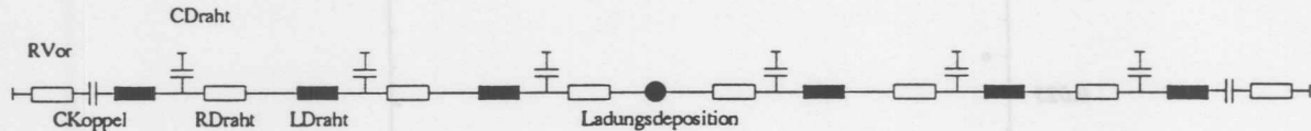
Abbildung 15: Ersatzschaltbild für einen Draht der CJC. Kapazität, Induktivität und Widerstand sind entlang des Drahtes verteilt und können als Kette mit unendlich vielen Gliedern beschrieben werden. An beiden Enden des Drahtes befinden sich die 1.5nF Koppelkondensatoren und die Vorwiderstände der Verstärker.
