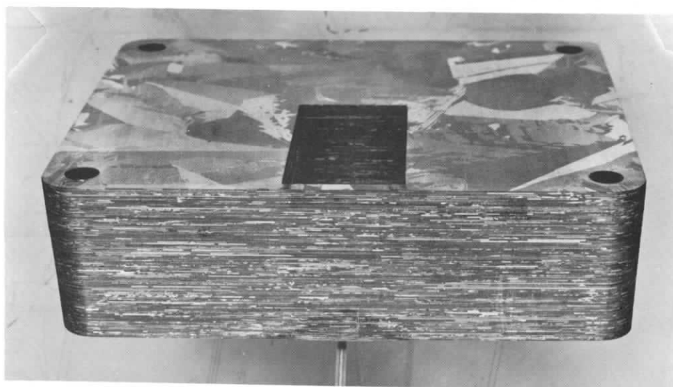
Abb. 9 GEÄTZTER FERTIGER MAGNETBLOCK (deutlich sind Grenzen der Kristallisationszonen zu erkennen)
