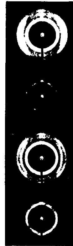
Abb. 54: Röntgenweitwinkelstreuung einer in z-Richtung mittelstark ( \Delta n_{Oz} \approx 90 \cdot 10^{-3} ) ver Streckten Polyethylenterephthalat-Folie nach der Kristallisation für \Delta n_{kz} = 0 . Parameter: Verstrecktemperatur T_{Vz} , T_{Vx} , Verstreckgeschwindigkeit \dot{\epsilon}_z , \dot{\epsilon}_x Strahl \perp Oberfläche
