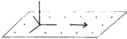
Abbildung 54. Gleitebenen-System  $\bar{a}$ -basal.: Für dieses Gleitebenen-System wurde hier das Beispiel einer  $(0001)$ -Gleitebene mit einer  $[\bar{1}120]$  Gleitrichtung gewählt.
