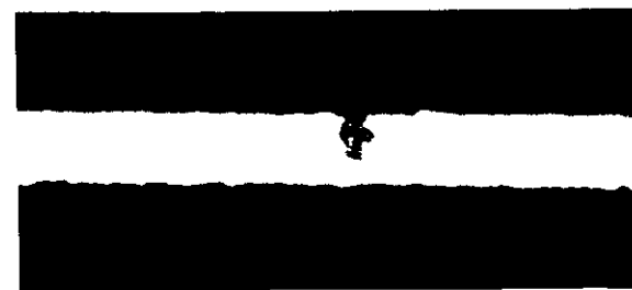
Abb. 24: mikroskopische Aufnahme eines durch Funken beschädigten Zähldrahtes (Durchmesser 40 \mu m) (aus DIM70)
