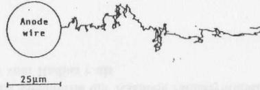
Abbildung 2.2: Simulierter Weg eines einzelnen Elektrons (aus [Mat85])
