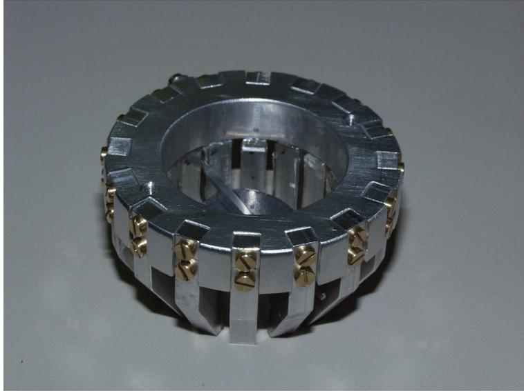
Abbildung 6.3: Der gebaute Fluoreszenzanalysator für Cu-K $_{\alpha}$ -Strahlung. Der Durchmesser der Analysatoröffnung beträgt  $\sim 3,3$ cm. 16 Kristallhalter mit aufgeklebten Kristallen sind in einem Ring verschraubt. Siehe auch die Abbildung 7.3 und den Anhang D.
