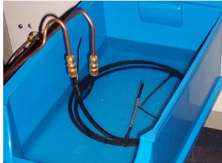
Abbildung 5.2: PVC-Schlauch im Wasserbad
