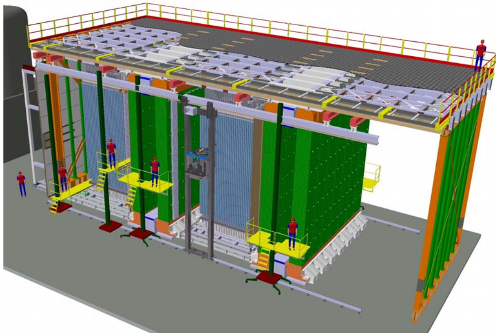
Abbildung 3.5: Aufbau des OPERA Detektors. Er ist aus zwei identischen Supermodulen zusammengesetzt. In diesem Bild kommt der Neutrinostrahl von der linken Seite und trifft auf das Target des ersten Super Moduls.
