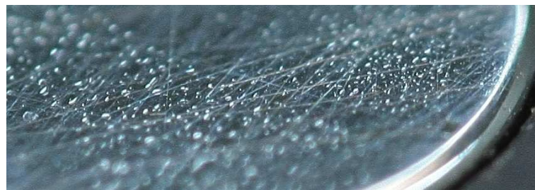
Abbildung 4.11: Spiegel des Taupunktmessgeräts mit Ablagerungen von Kleberückständen [Kau08].
