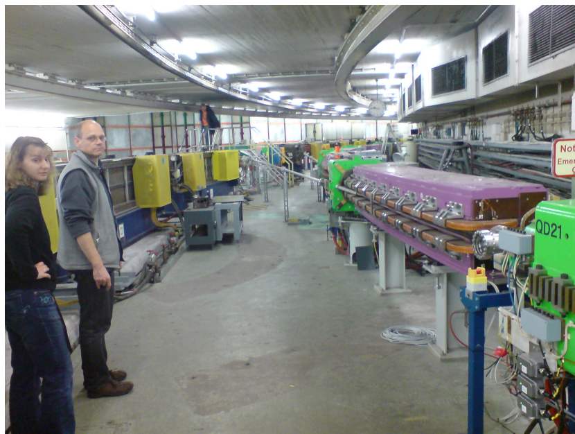
Abbildung 5.5: Blick in den DESY-Tunnel: DESY-II ist rechts im Bild (grün/violett), auf der linken Seite befindet sich das z.Zt. stillgelegte DESY-III (blau/gelb ehemaliges DESY-I), in der Bildmitte sind die aus dem Ring abzweigenden Strahlrohre der Teststrahlen 21 und 22 zu sehen.
