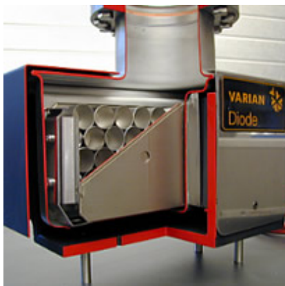
Abbildung 9 - Schnitt durch eine Ionengetterpumpe [13]
