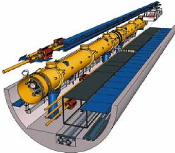
Bild 6: Geplanter Aufbau des ILC-Tunnels [3]
