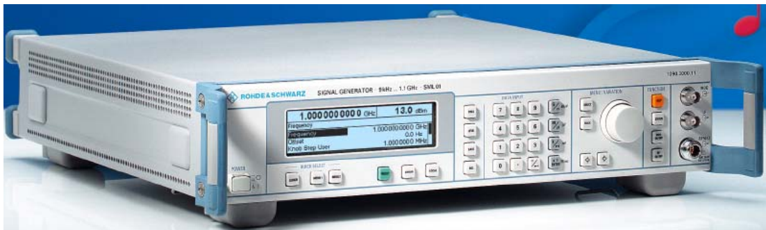
Bild 33: Sinusgenerator (Rhode &amp; Schwarz SML 02)
