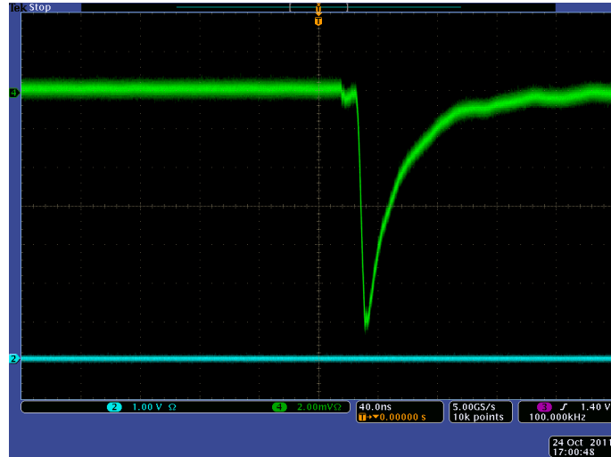
Abbildung 33: Ergebnis der blauen LED des Herstellers Lumitronix (ArtNo. 15404) im Schaltsystem des LED-Driver-Boards. (Zeitachse: 40ns/div. Intensität: 2mV/div.). Auch in dieser Betriebsart der LED bleibt das Signal kurz genug.
