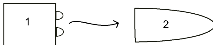
Abbildung 36: Funktionsskizze zum experimentellen Aufbau zur Maximierung des Spannungsflusses des LED-Driver-Boards mit einem Photmultiplier. Das LED-Driver-Board System (1) sendet beim Betrieb zweier LED's Licht aus, das vom Photomultiplier detektiert wird (2). Beide Komponenten dieses Aufbaus befinden sich in der lichtundurchlässigen „Blackbox“.
