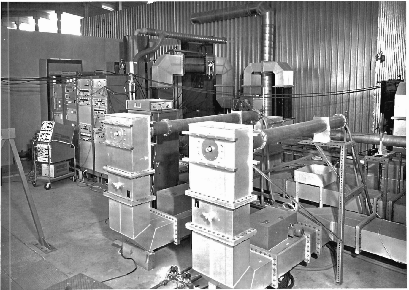
Bild 48: Der Prototyp eines Klystron-Senders und der Hohlleiteranlage für den Speicherring.
