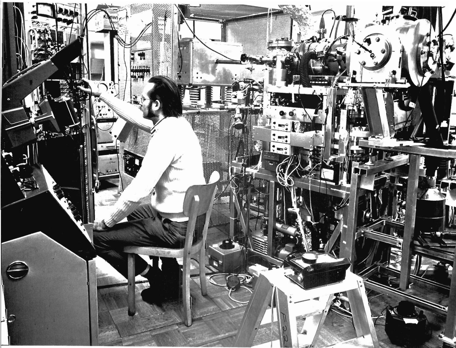
**Bild 68** : Die Apparatur. Von rechts nach links: Elektronenpolarisations-Analysator nach Mott, Magnetische Falle und Spinaustauschkammer, Fallen-Logik auf Hochspannungsniveau
