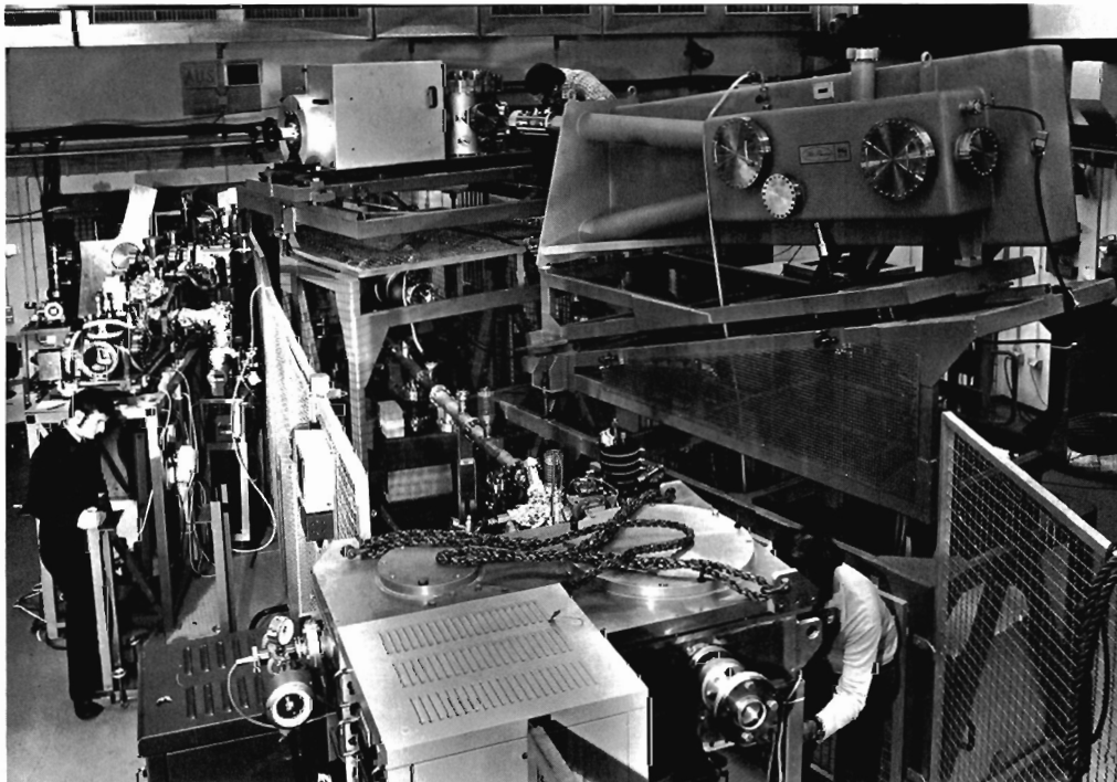
Abb. 69 Blick in das kürzlich in Betrieb genommene Labor am Speicherring für Experimente mit der Synchrotronstrahlung. Rechts oben der hochauflösende Monochromator HONORMI, weiterhin die Experimente HIGITI (links), FLEUR (Mitte). (23068/41)
