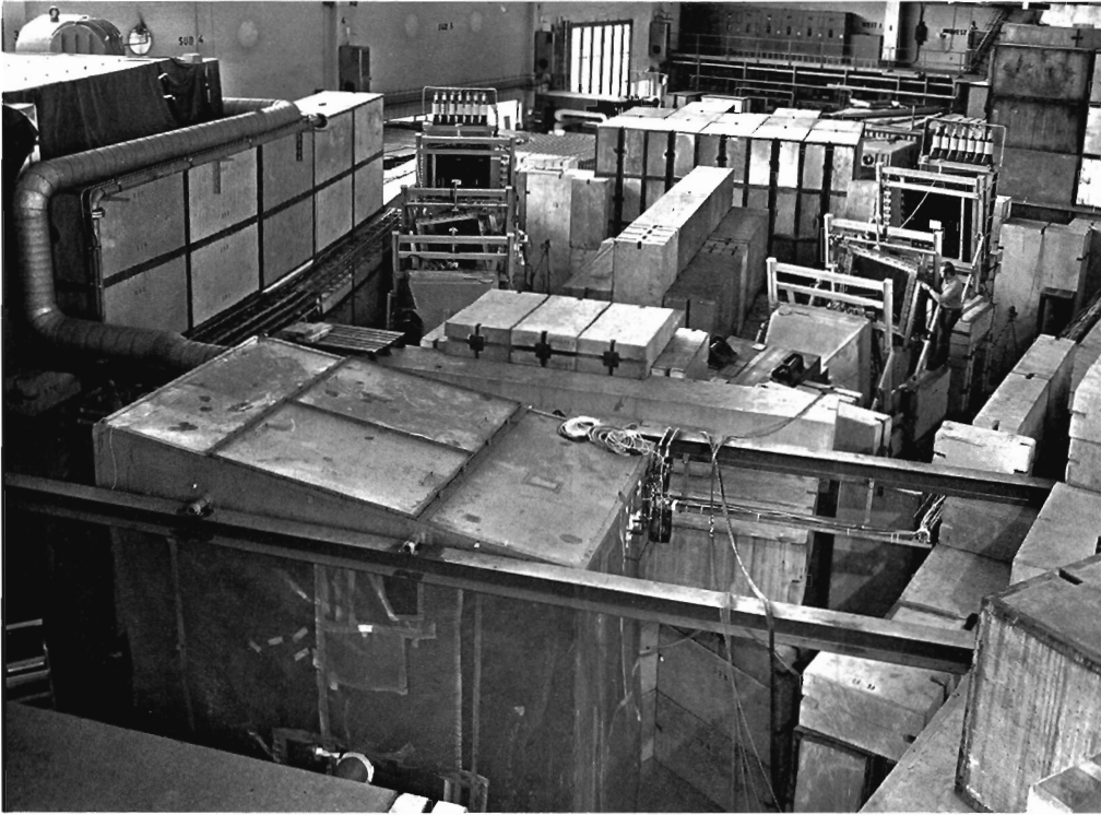
Abb. 33 Zweiarmspektrometer zur Beobachtung der e^+e^- , K^+K^- und \pi^+\pi^- -Paarerzeugung (23068/11)
