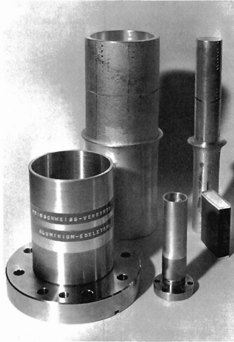
Abb. 90 Reibgeschweißte Aluminium-Edelstahl-Übergänge (REPI-Verfahren) (23932/15)
