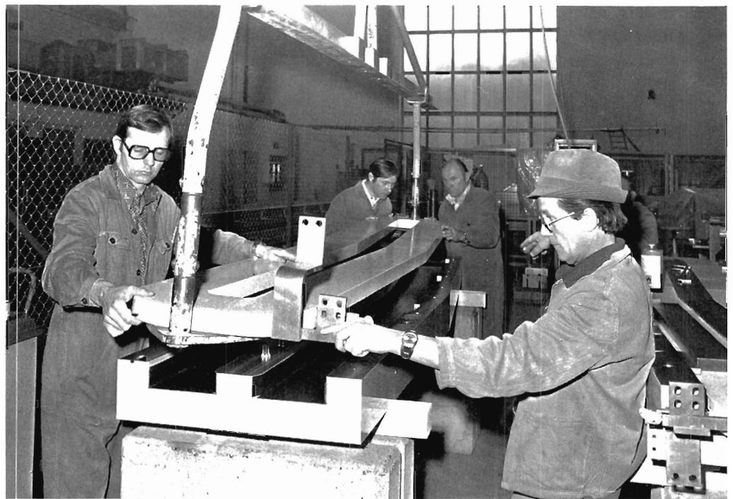
Abb. 87/88 Montage der Injektionsdipole
