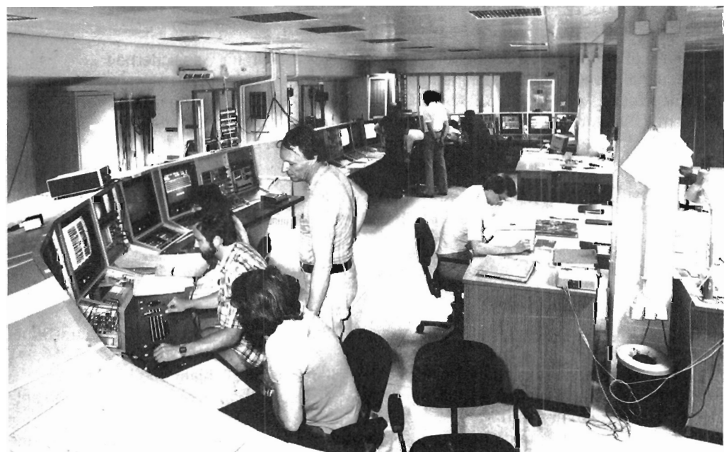
Abb. 17.4: Sämtliche Beschleuniger bei DESY werden im zentralen Kontrollraum überwacht und gesteuert.
