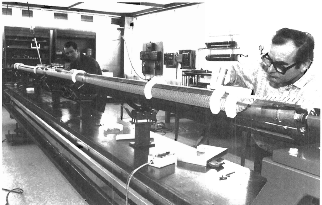
Abb. 22.1: Herstellung einer originallangen HERA-Dipol-Prototypspule.
