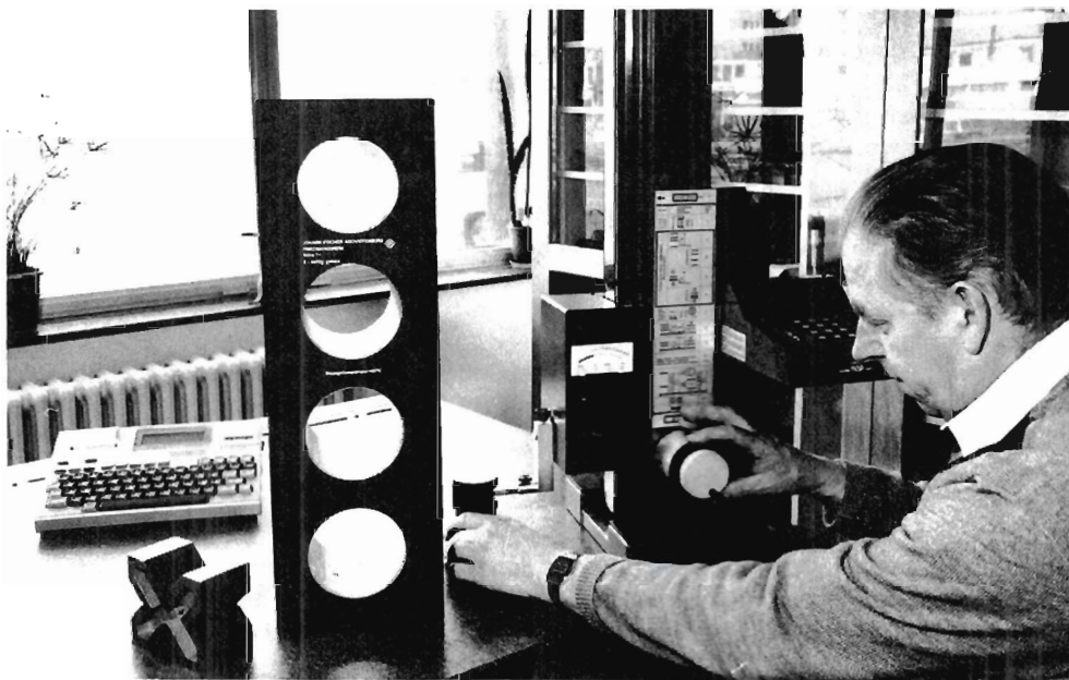
Abb. 22.9: Digitales Höhenmeßgerät mit Mikroprozessor für die Fertigungskontrolle.
