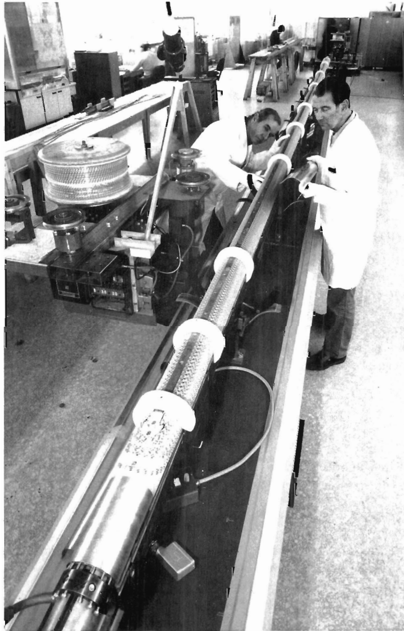
Abbildung 82: Die Spulen für die 9 m langen Prototypen der HERA-Kalteisen-Dipole wurden bei DESY gewickelt und geklanunert. (38156/14)
