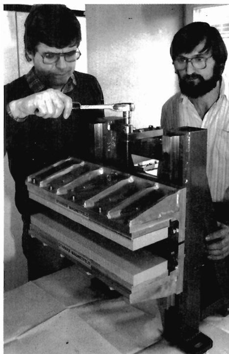
Abbildung 71: Der Miniwiggler W3 vor dem Einbau in den Speicherring DORIS II. (39632/32)
