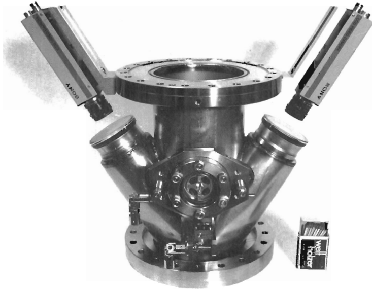
Abbildung 113: Von den DESY-Werkstätten gebauter Čerenkov-Zähler für das Wiggler-Projekt. (40397/33)
