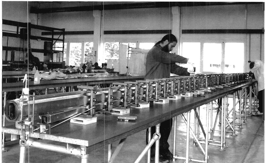
Abbildung 79: Zusammenbau einer Vakuumkammer für den HERA-Elektronenring im DESY-Vakuumlabor. (40601/27)
