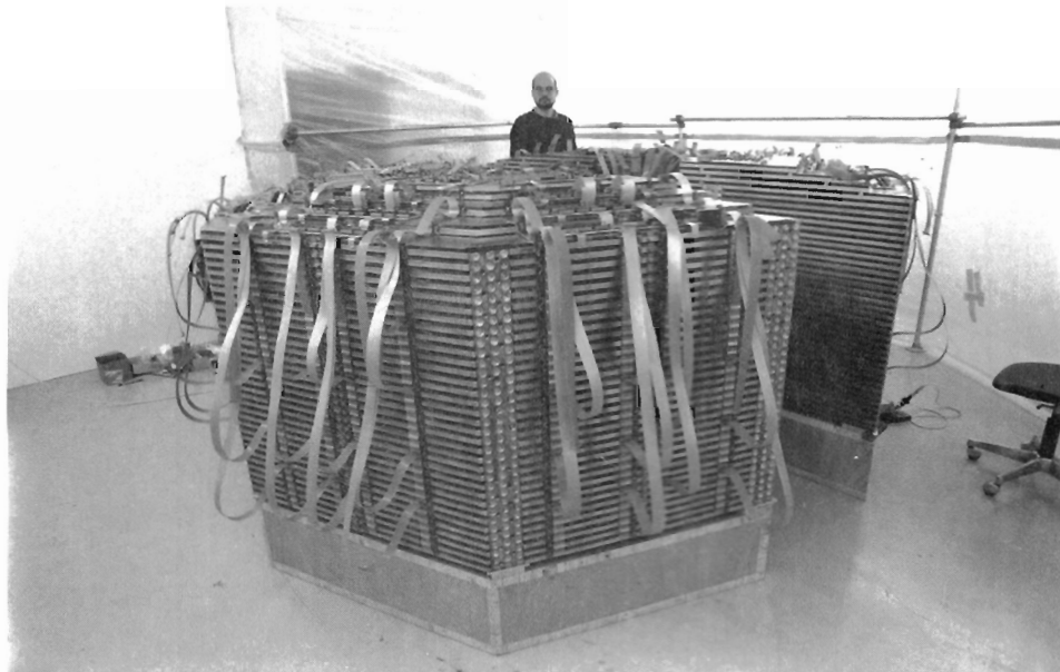
Abbildung 8: Die beiden hadronischen Vorwärtskalorimeterstacks IFH. Die Stacks sind vollständig mit den Ausleseeinheiten bestückt. Die Verkabelung ist praktisch abgeschlossen. (Foto P. Waloschek)
