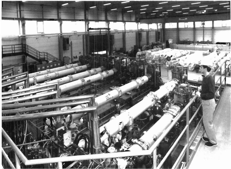
Abbildung 68: Blick in die Magnettesthalle mit sieben Testständen für supraleitende Dipole und einem Quadrupolstand. (41852/17)
