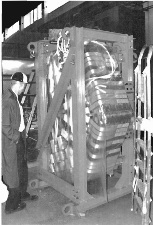
Abbildung 7: Halbstack des elektromagnetischen Vorwärtskalorimeters IFE. Zur Überprüfung der Mechanik und der Hochspannungsfestigkeit wurde das Kalorimeter-Modul in die Vertikale aufgerichtet. (Foto P. Waloschek)
