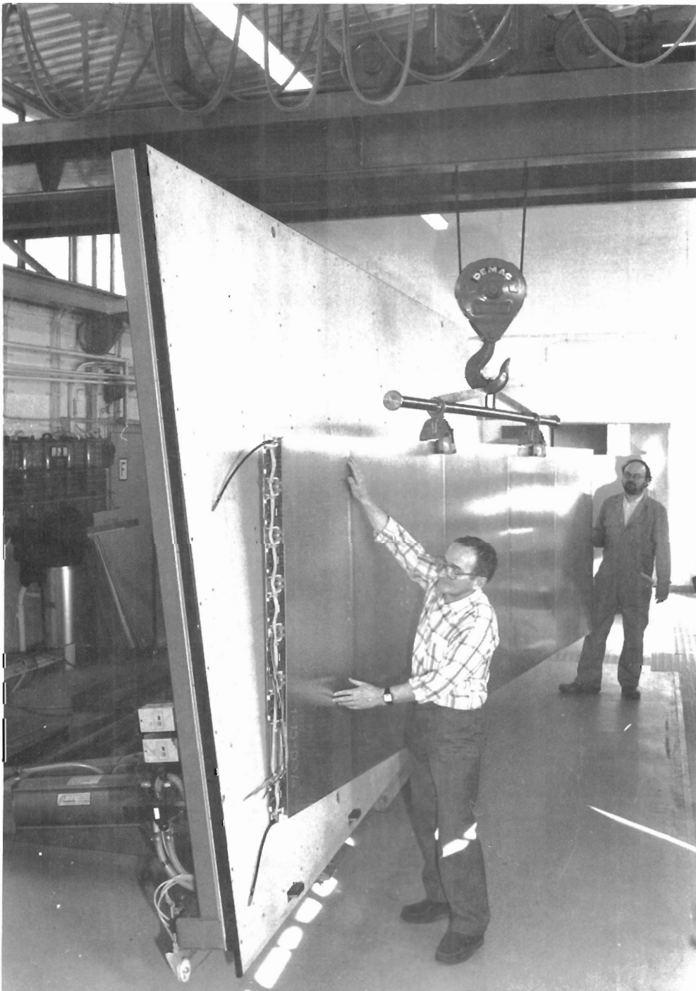
Abbildung 10: Transport einer Streamertube für die Eiseninstrumentierung. Die großflächigen Zählrohrkammern wurden aus sicherheitstechnischen Gründen aus halogenfreiem Luranyl gefertigt. Die Betriebserfahrungen mit diesen Kammern, gewonnen am CERN-Teststrahl, sind positiv. (42001/9)
