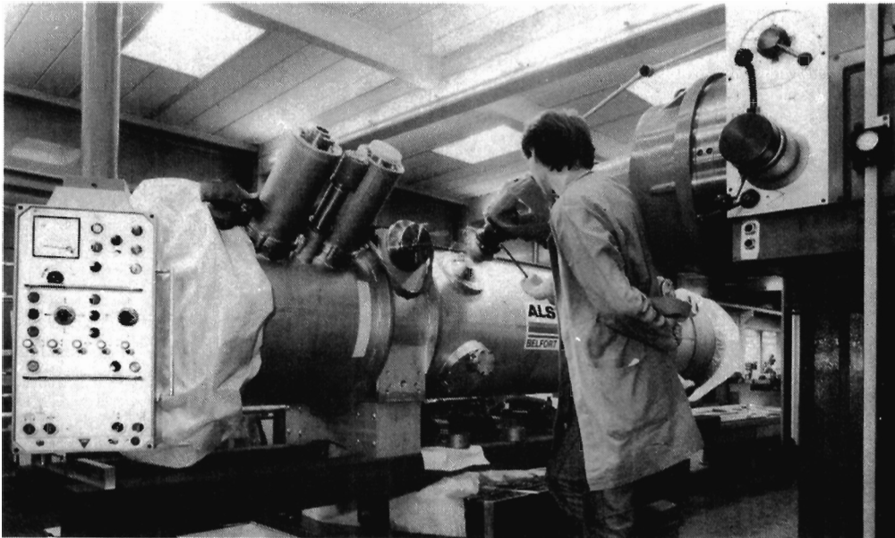
Abbildung 112: Reparatur eines supraleitenden Quadrupols auf dem Bohrwerk der Hauptwerkstatt (42111/17)
