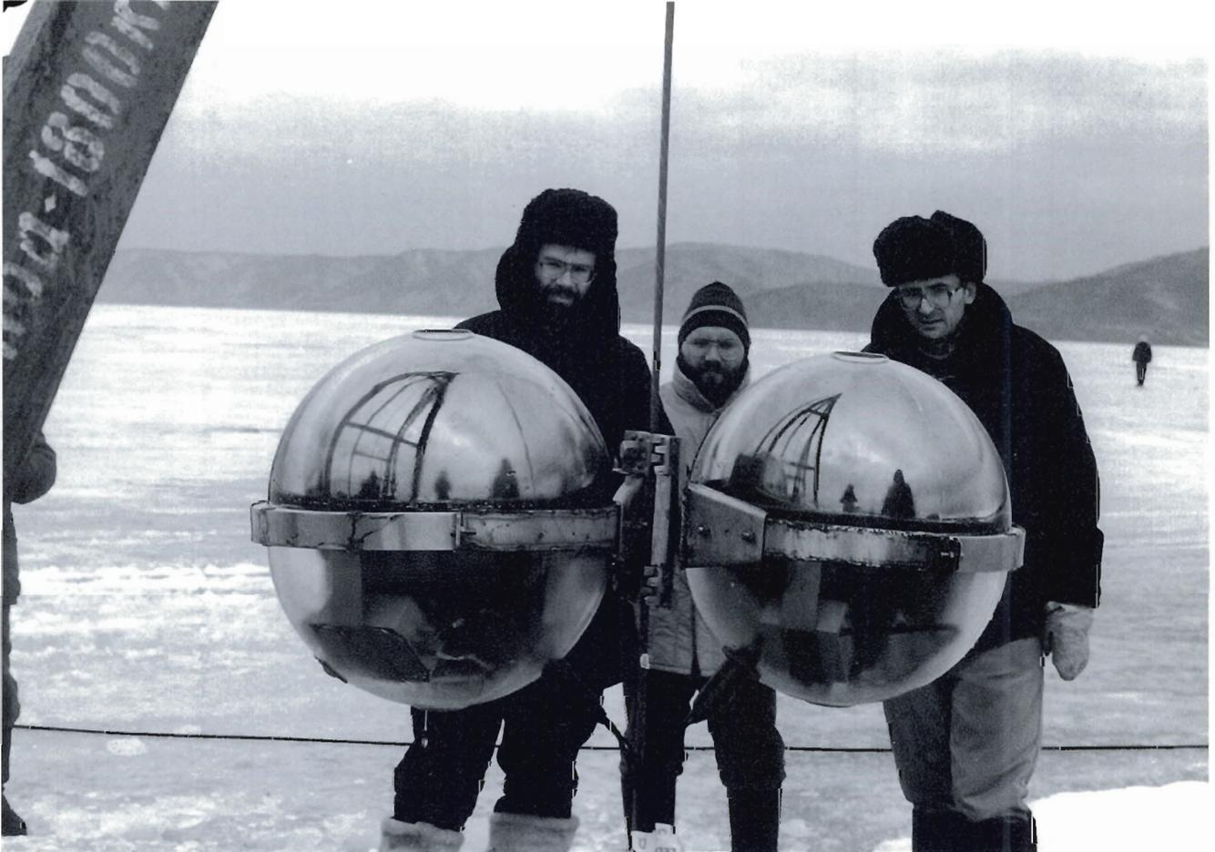
Abbildung 64: Zwei optische Unterwasserdetektoren vor dem Absenken in den Baikalsee.
