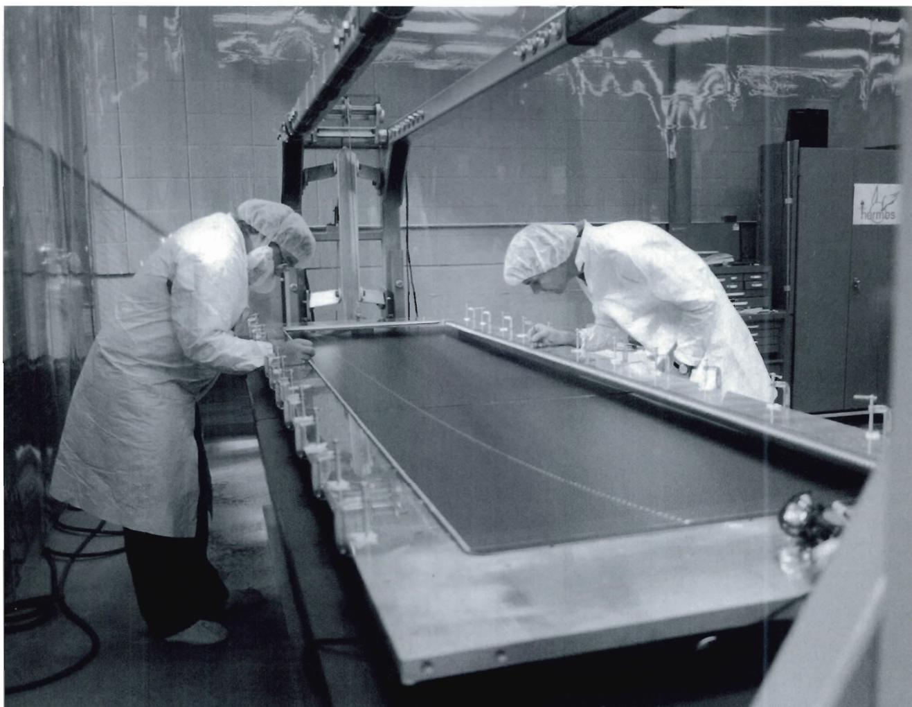
Abbildung 29: Das erste Modul des Übergangsstrahlungsdetektors wird am TRIUMF-Institut in Vancouver/CAN im neuen HERMES-Reinraum verdrahtet. Die Drähte sind an Reflexionen des Lichts zu erkennen.
