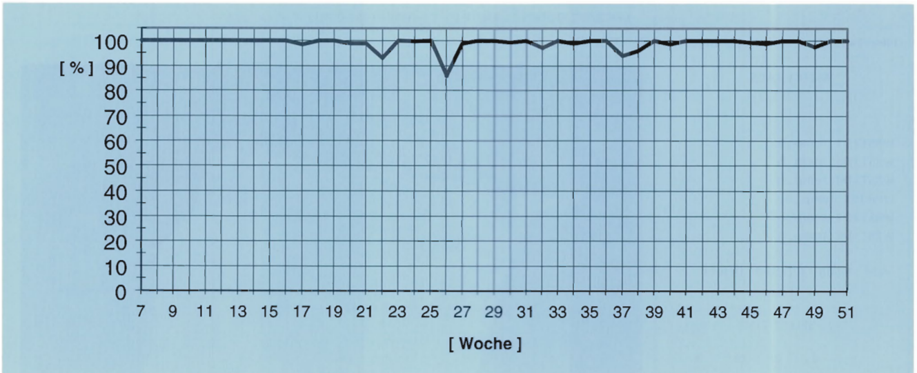
Abbildung 96: Verfügbarkeit der Kälteanlage in 1995.
