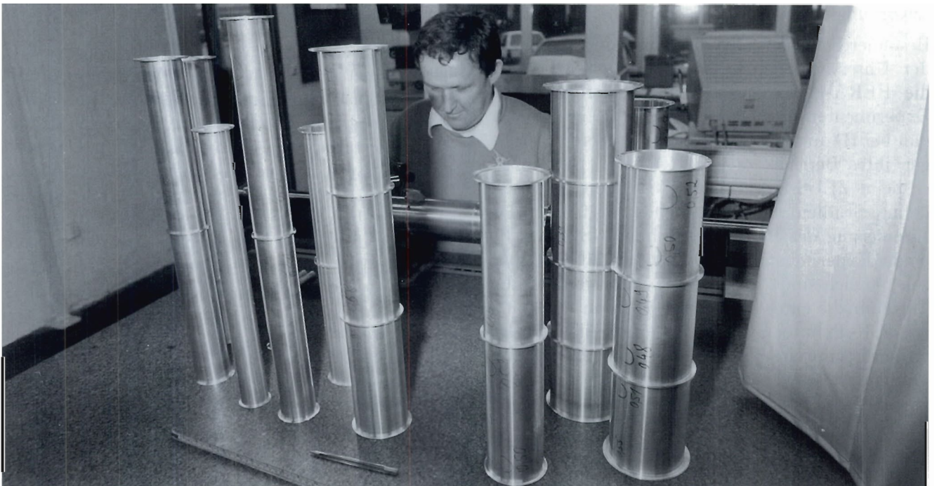
Abbildung 37: Die einzelnen Segmente des 6.7 m langen Strahlrohr-Prototypen, der im Frühjahr 1996 in den HERA-Protonenring eingebaut werden soll. (42710/15)
