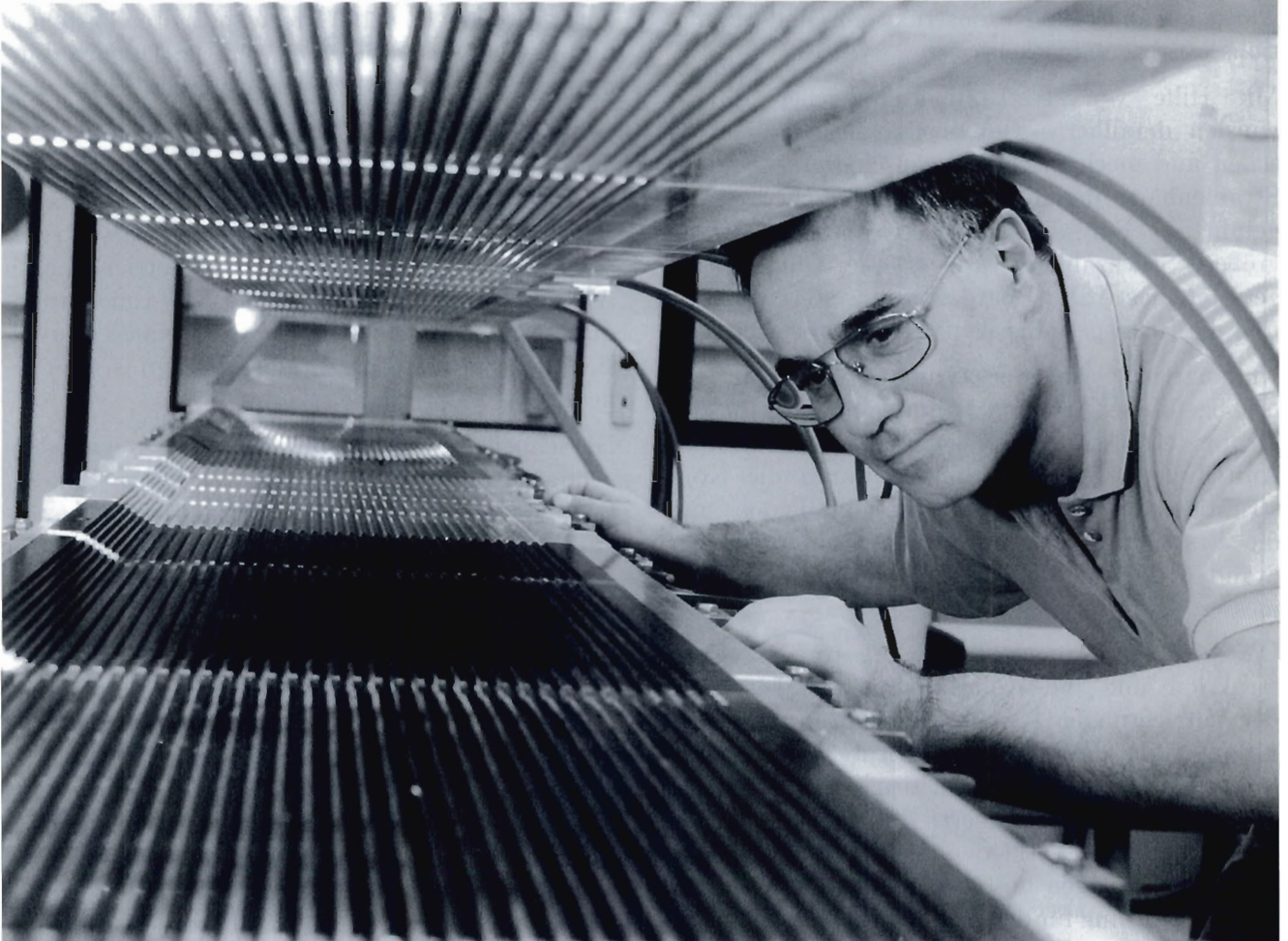
Abbildung 72: Herstellung eines Prototyp-Moduls der Honeycomb-Driftkammer für HERA-B in einer Fertigungsform. (Foto: Fotoagentur Zentralbild GmbH)
