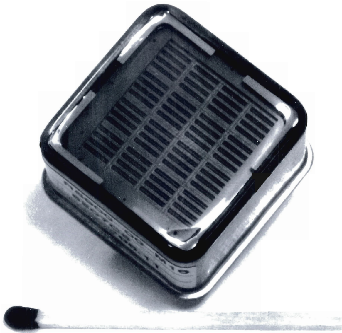
Abbildung 40: Vielanoden-Photovervielfacher (M16) für den Einsatz im HERA-B RICH-Detektor.
