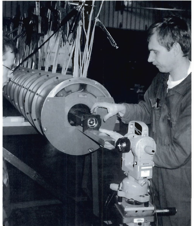
Abbildung 108: Der Ersatzabschnitt des LINAC II besteht aus zwei Korrekturspulen und 18 Einzelgehäusen mit jeweils zwei Solenoid-Spulen, deren Vermessung und Ausrichtung mit der Methode des magnetischen Zeigers durchgeführt wurde. Die Abbildung zeigt die Meßvorrichtung beim Zusammenbau der Einzelabschnitte. Die magnetische Nadel wird auf der Teilchensollbahn bewegt. (Foto: K. Sinram)
