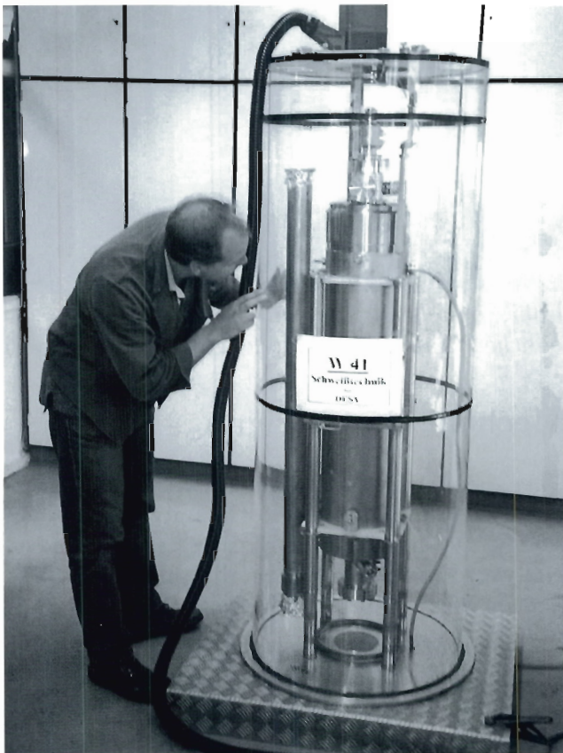
Abbildung 122: WIG-Schweißung des Titan-Cavity-Tanks unter Ar-Schutzatmosphäre. (Foto: J. Dicke)
