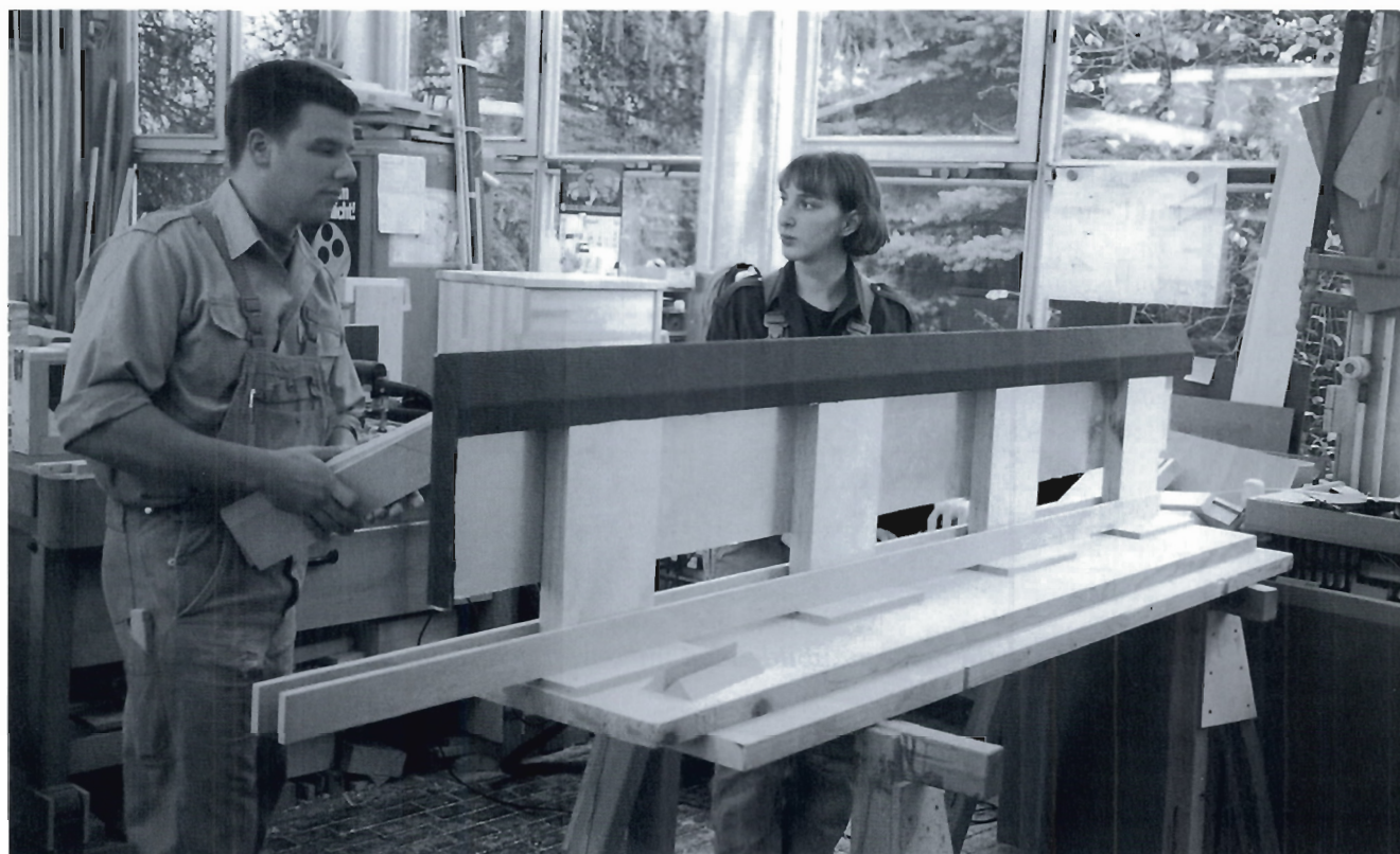
Abbildung 127: Schnittschablone für die Abdeckkappen des „Outer Tracker“-Detektors von HERA-B.
