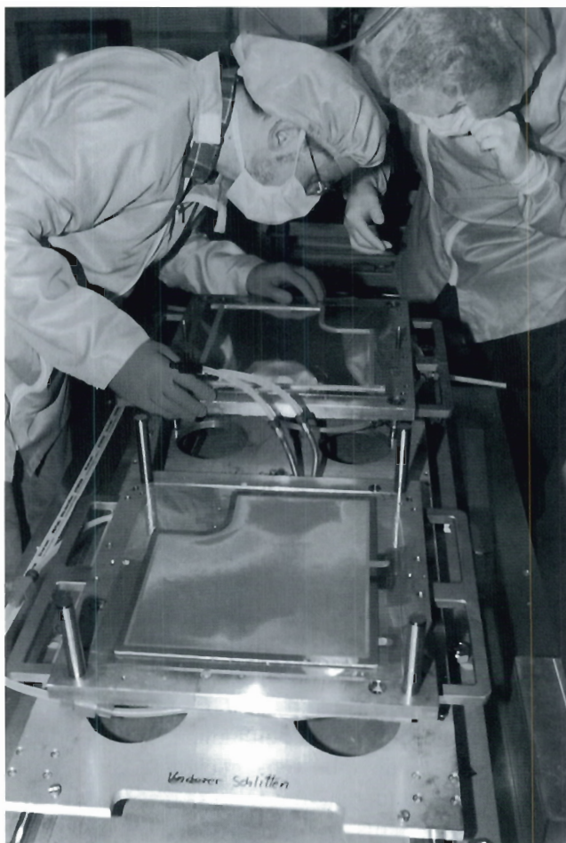
Abbildung 52: Zusammenbau einer GEM-MSGC unter Reinraumbedingungen. Im Hintergrund die MSGC-Platte mit Rahmen, im Vordergrund die vorgespannte GEM-Folie.
