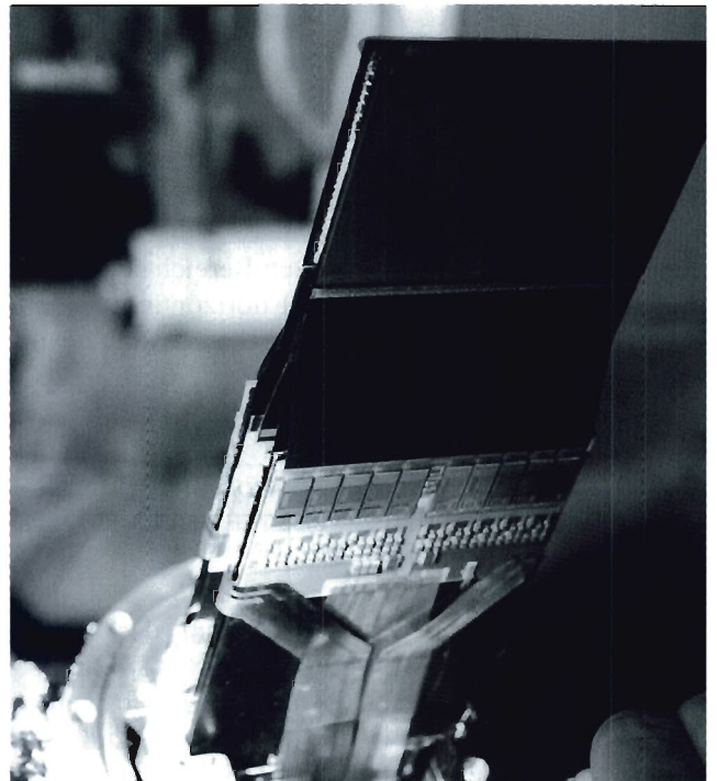
Abbildung 50: Blick auf den oberen Teil eines Detektortopfes für die Quadranten der vierten Superlage mit zwei doppelseitigen Siliziumstreifen-zählern und den Elektronik-Komponenten für die dem Betrachter zugewandte Detektorseite: Mikroadapter und Keramikhybrid mit zehn Helix 2.1-Auslesechips.
