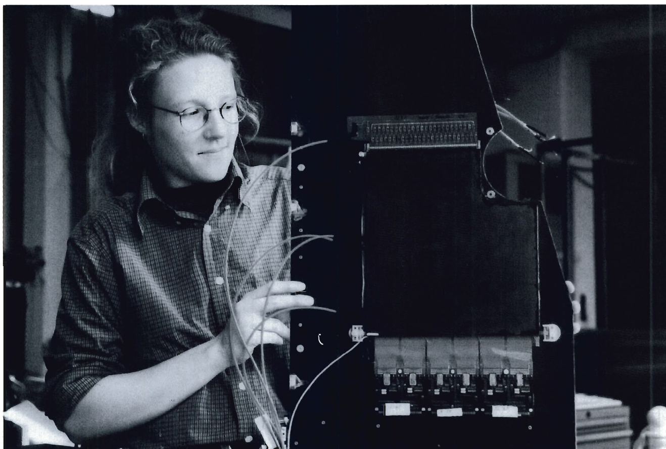
Abbildung 53: MSGC-Detektor auf seiner CFK Tragestruktur mit den angeschlossenen Auslesekarten mit jeweils zwei Helix-Chips.
