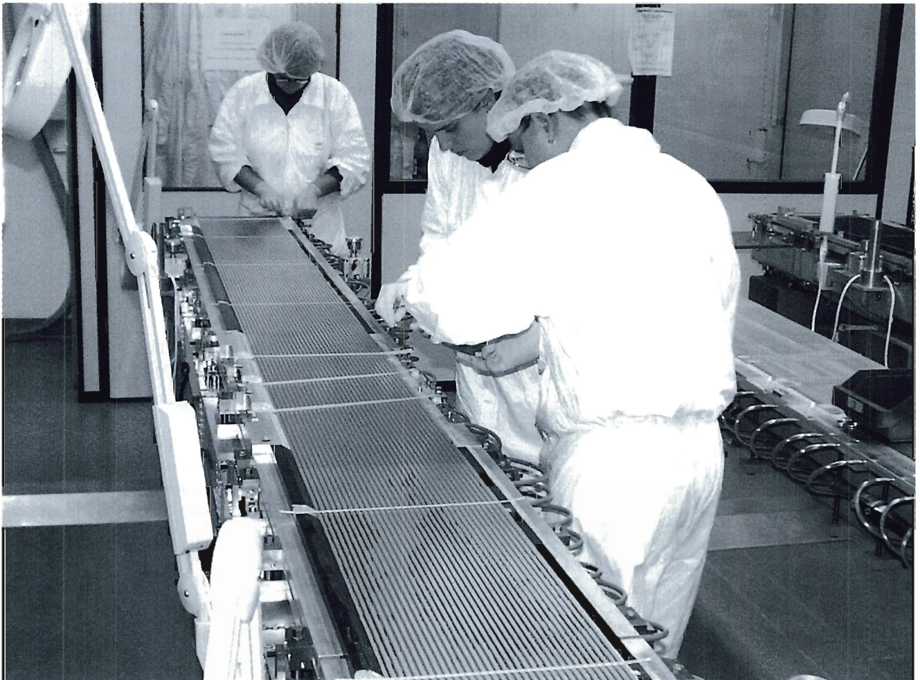
Abbildung 88: Montagearbeiten an einem TC-Modul.
