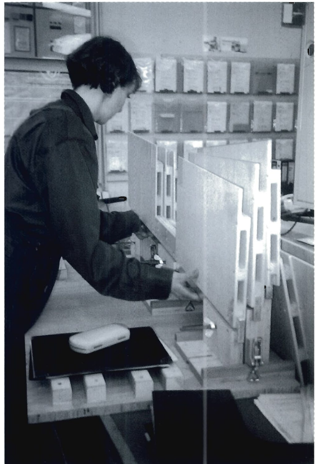
Abbildung 130: Klebevorrichtung für die Kappenherstellung der Outer Tracker-Kammern HERA-B.
