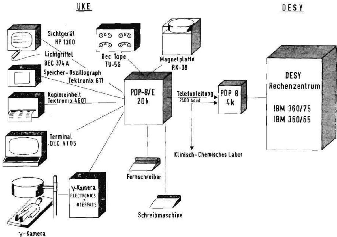
Bild 64: Die Konfiguration zur Auswertung nuklearmedizinischer Daten
