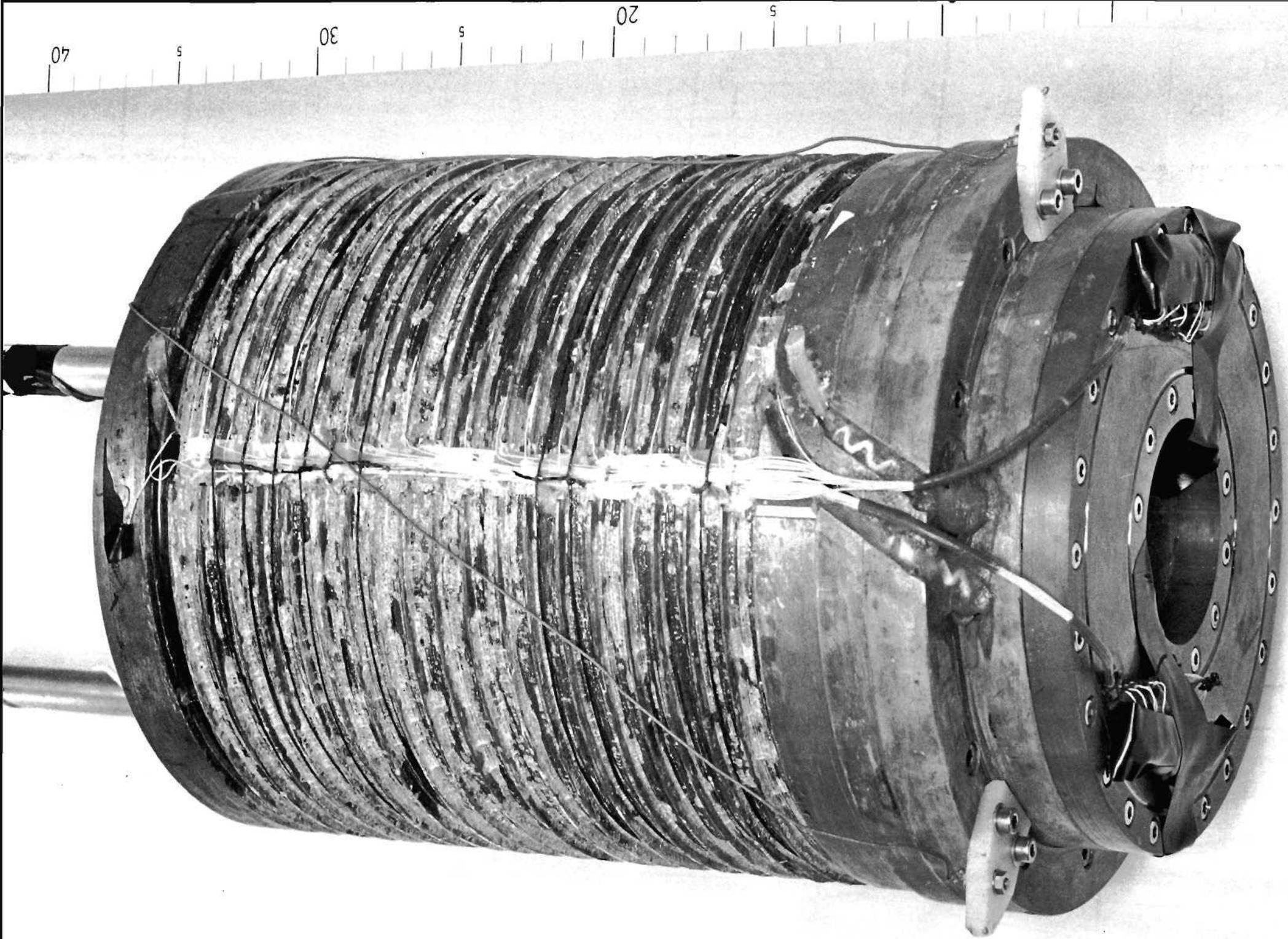
**Bild 67:** Supraleitende Spule mit einem maximalen Feld von 2,66 Tesla und Kühlung durch Wärmeleitung
