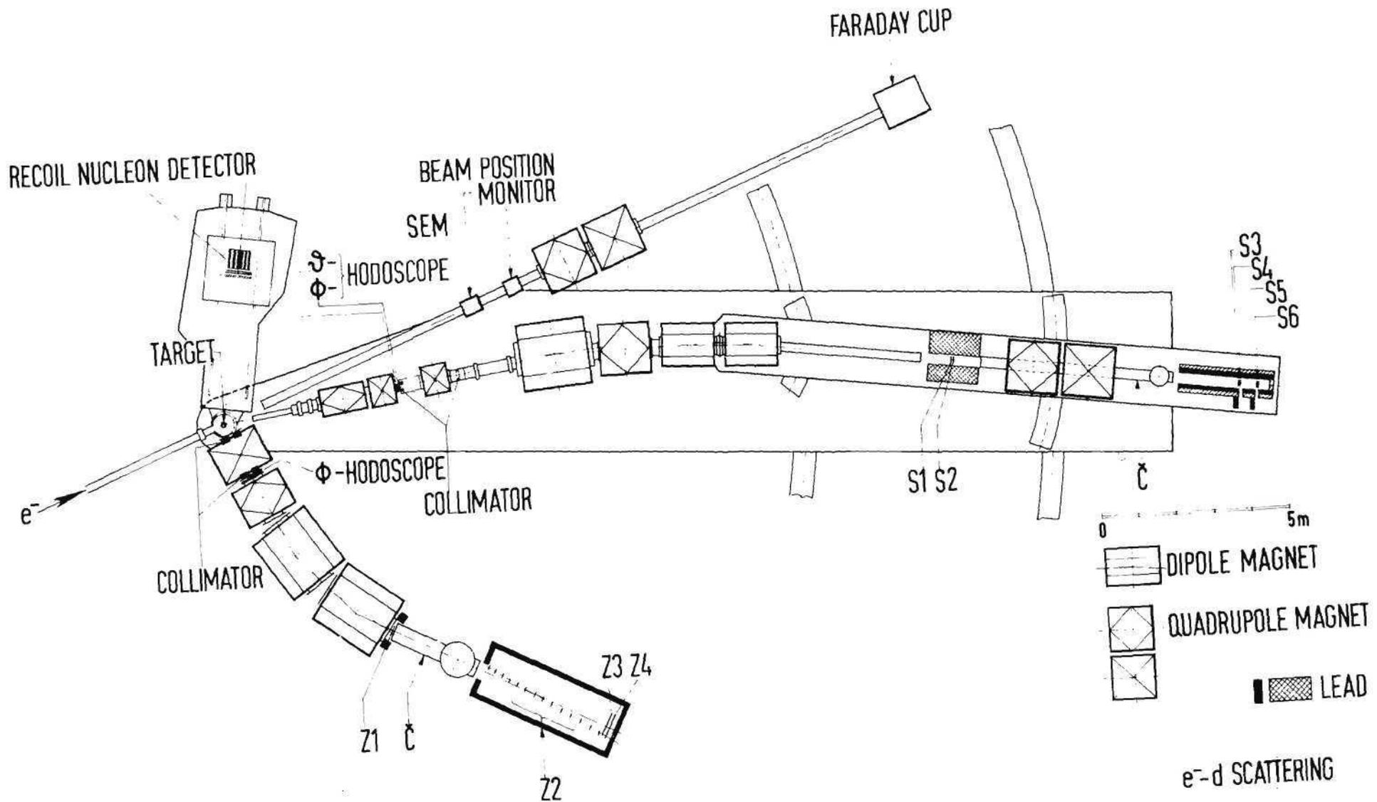
Bild 13: Aufbau der experimentellen Apparatur zur Messung der Formfaktoren von Nucleonen (Zwei Spektrometer zum Nachweis der Elektronen bei kleinen bzw. großen Streuwinkeln und ein Zähler zum Nachweis der Rückstoßnucleonen.)
