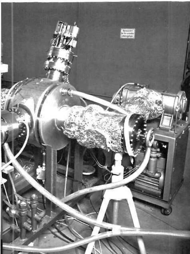
**Bild 49:** Der Prototyp einer Beschleunigungsstrecke auf dem Teststand .
