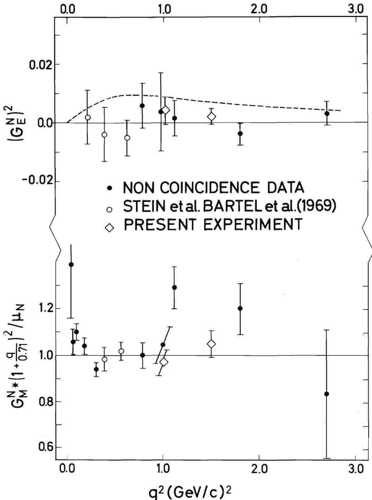
Bild 14: Verlauf der elektromagnetischen Formfaktoren des Neutrons in Abhängigkeit vom Impulsübertrag  $q^2$ . Zur Bestimmung der Werte wurden nur Experimente zur quasielastischen Elektron-Deuteron-Streuung herangezogen.
