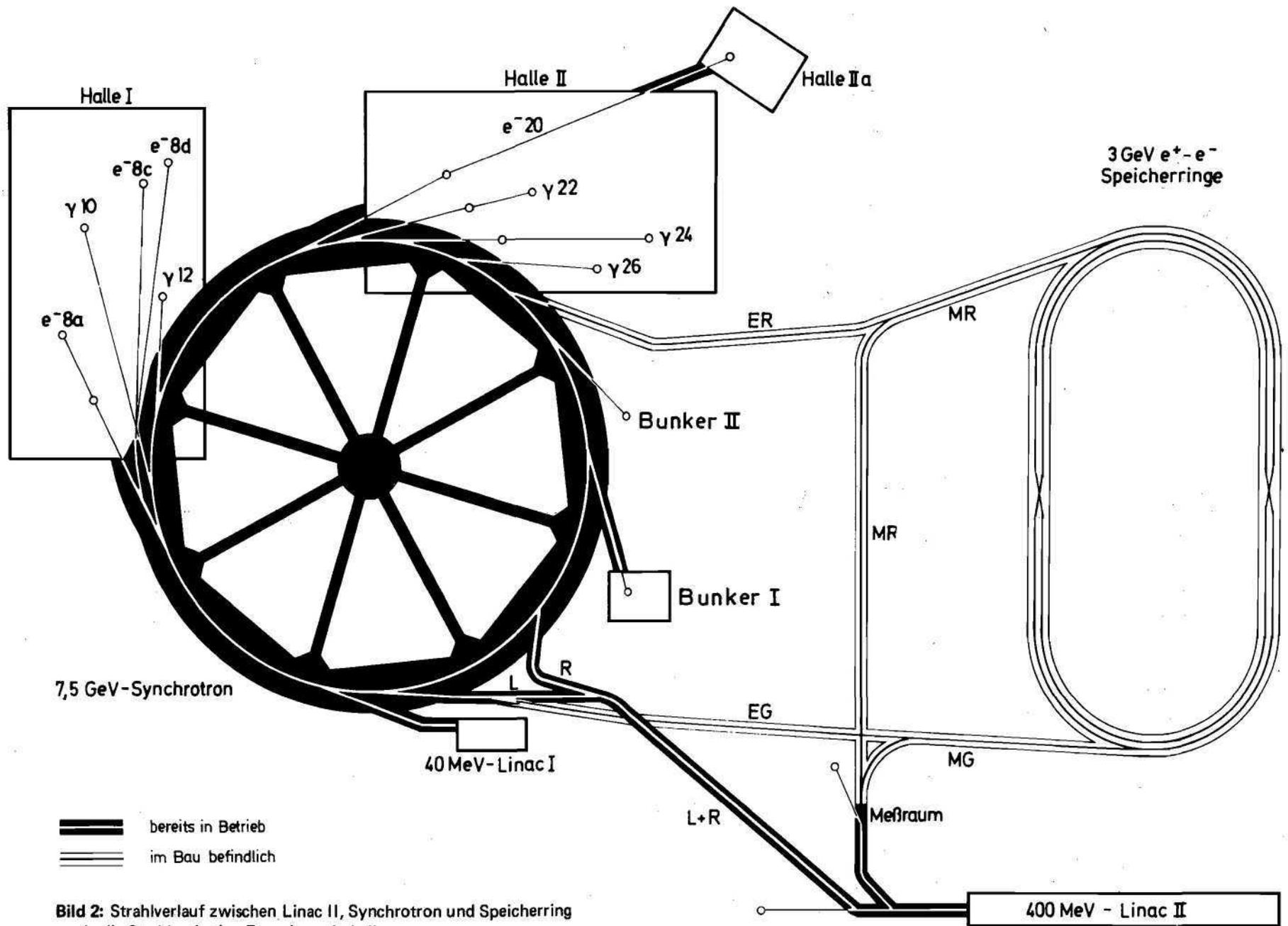
**Bild 2:** Strahlverlauf zwischen Linac II, Synchrotron und Speicherring sowie die Strahlen in den Experimentierhallen
