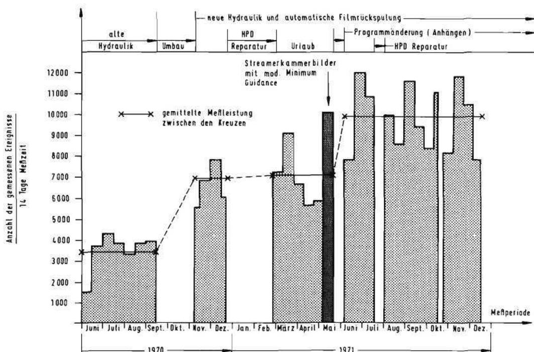
Bild 59: Meßleistung der HPD-Anlage
