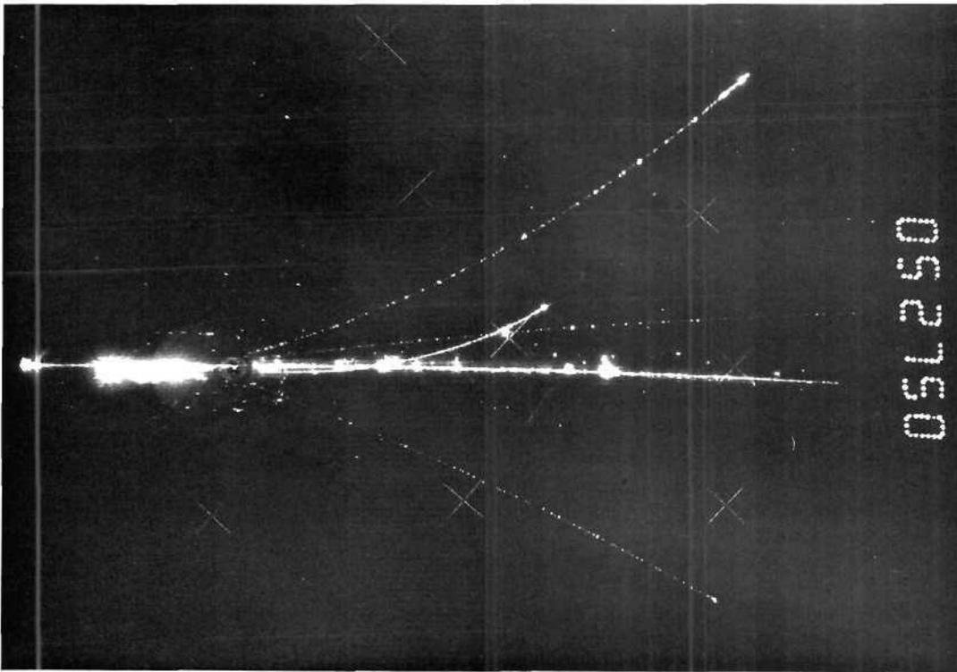
**Bild 9:** Beispiel einer Photographie aus der DESY - Streamerkammer. In der Mitte verläuft der Elektronenstrahl, darüber ist die Bahn des Trigger-Elektrons zu erkennen. Die beiden langen Spuren rühren von  $\pi$ -Mesonen her, während die kurze, kräftige Spur ein Proton darstellt
