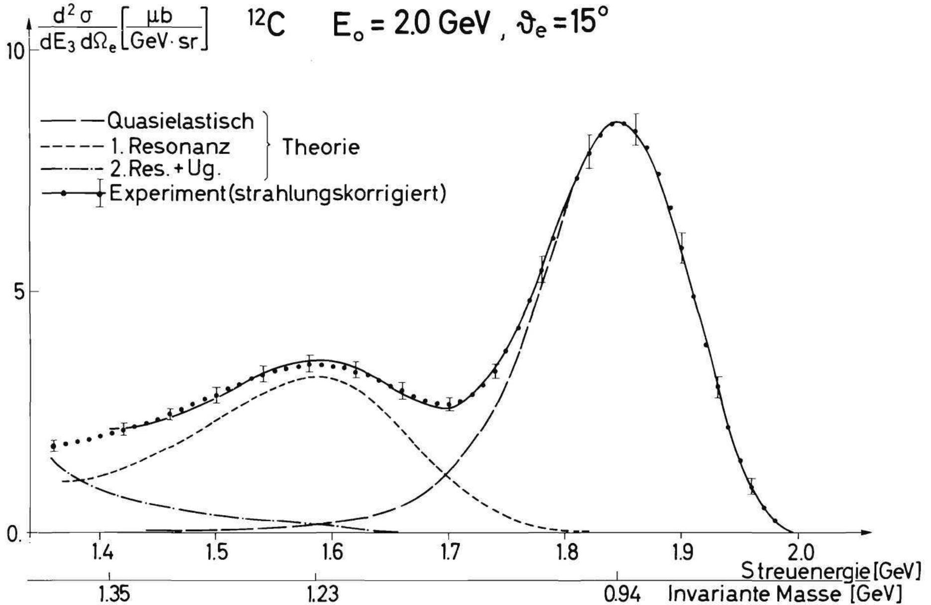
Bild 19: Elektronenspektrum für die Streuung an  $\text{C}^{12}$  im Gebiet des quasielastischen Maximums und der  $\Delta(1236)$ -Resonanz.
