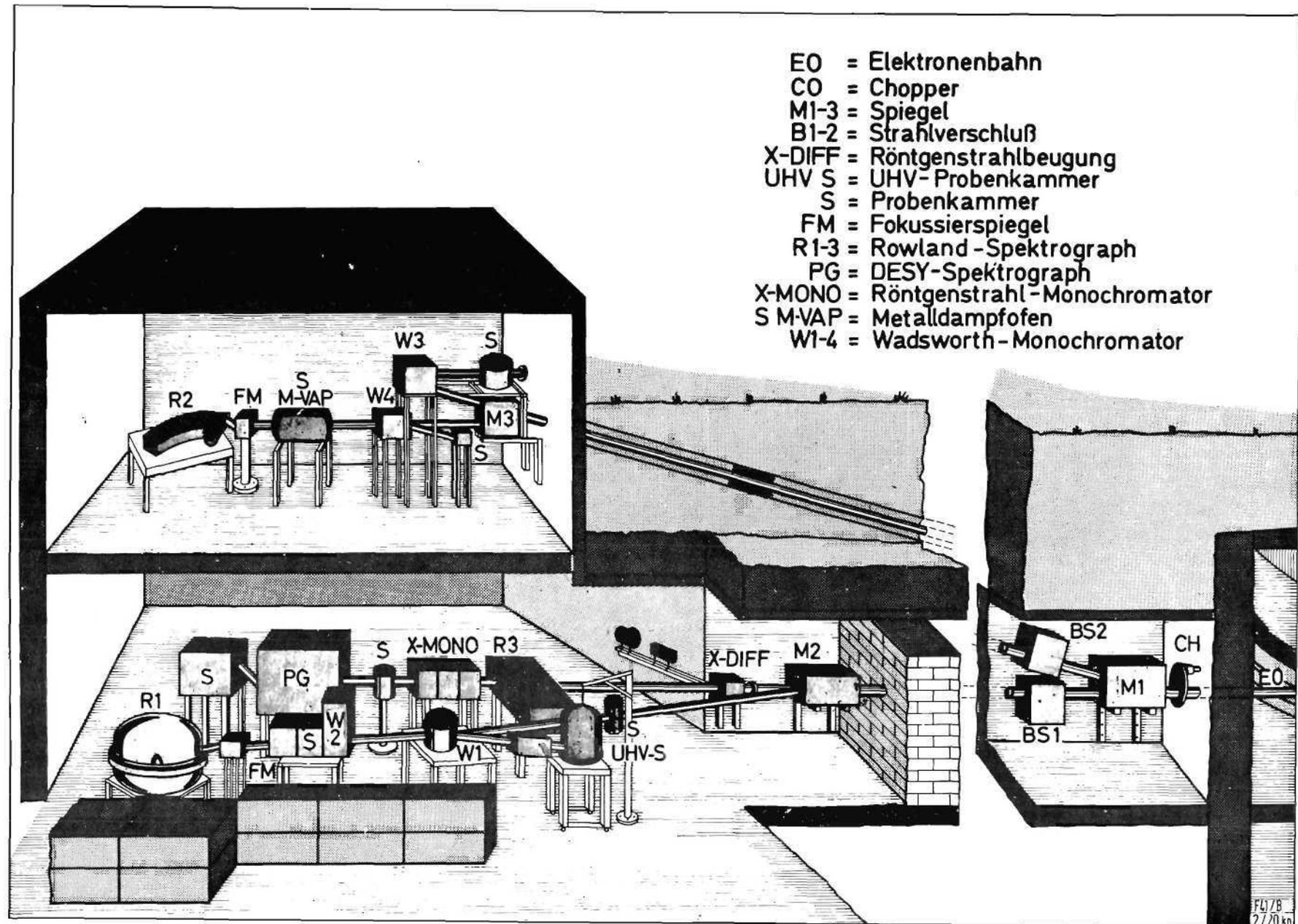
Bild 37: Der Aufbau des Laboratoriums für Untersuchungen mit der Synchrotronstrahlung.
