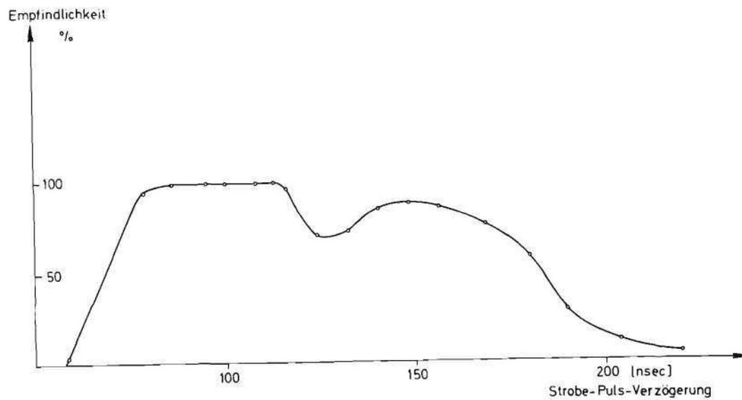
**Bild 22b:** Ansprechwahrscheinlichkeit bei einem Teilchendurchgang unter  $15^\circ$  zur senkrechten Richtung.
