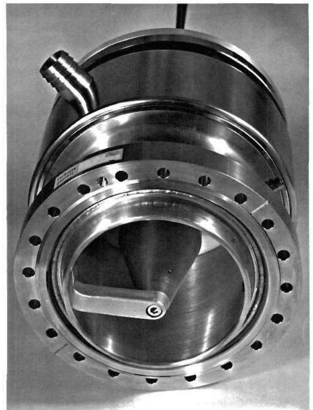
**Bild 50:** Koaxiales Hochfrequenzfenster zur Leistungseinkopplung in die Beschleunigungsstrecken.
