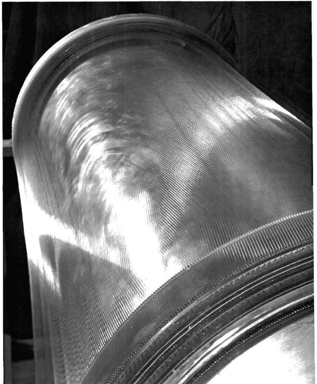
**Bild 32:** Zylindrische Proportional-Kammer
