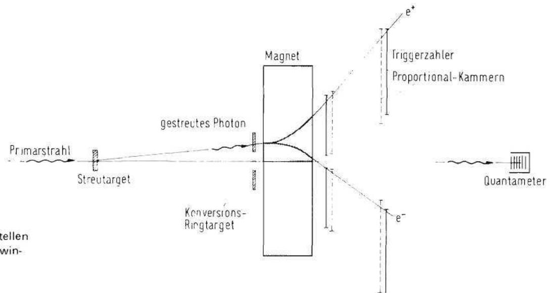
**Bild 34:** Prinzip des experimentellen Aufbaus zur Messung der Kleinwinkelstreuung von Photonen.
