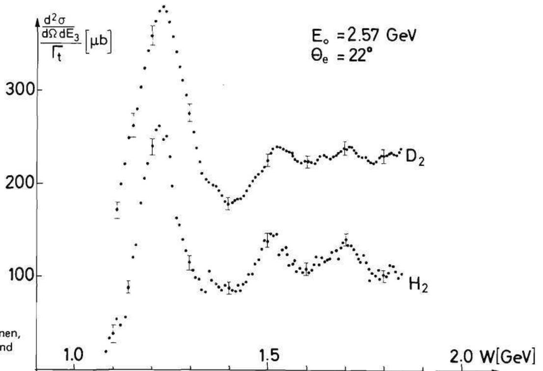
Bild 17: Spektrum der Elektronen, die inelastisch an Wasserstoff und Deuterium gestreut wurden.
