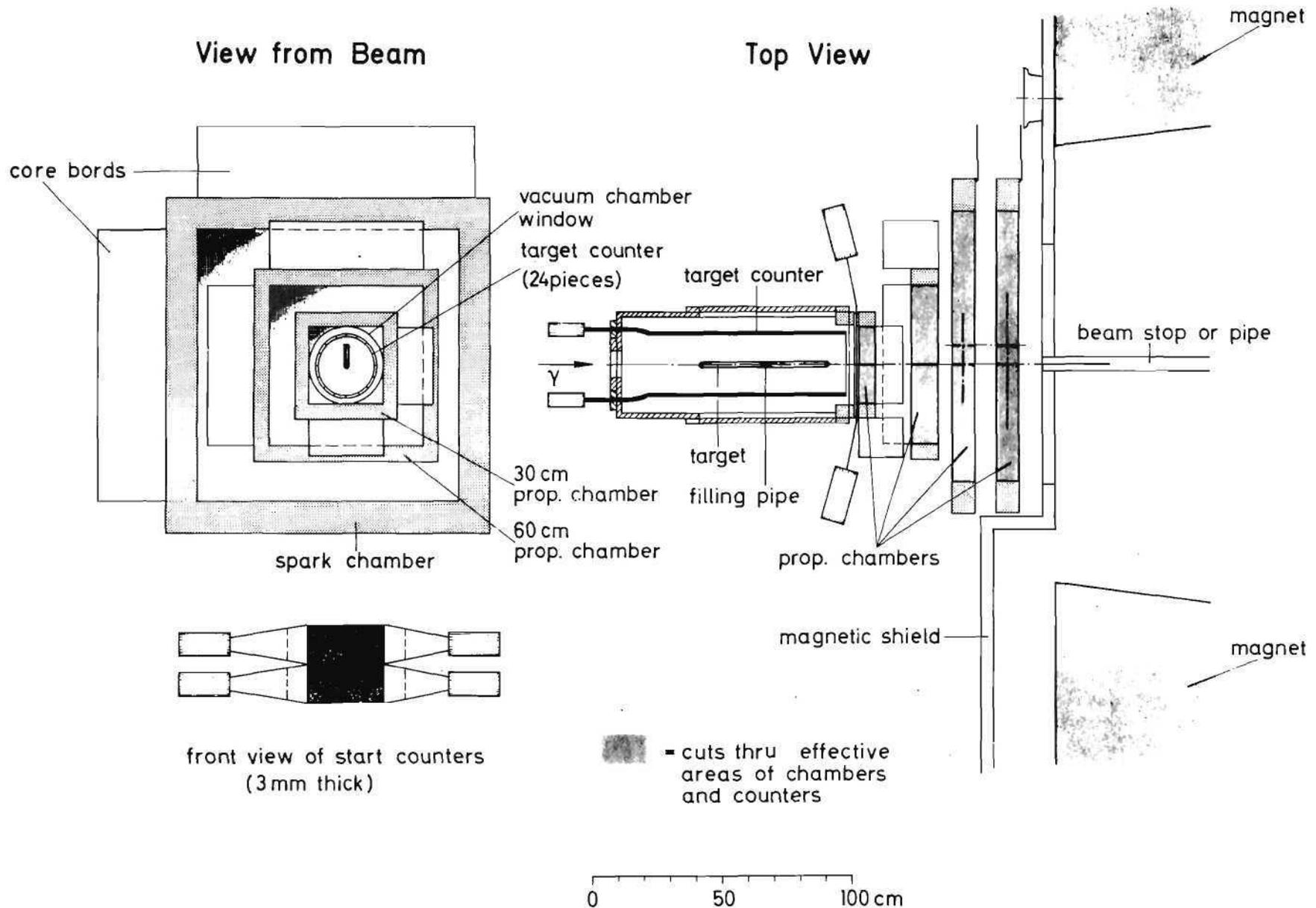
Bild 23: Anordnung von Zählern und Proportionalkammern in Targetnähe.
