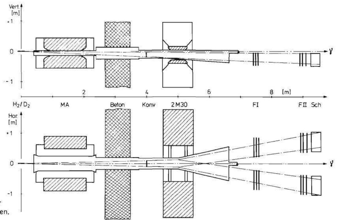
**Bild 31:** Die Meßanordnung zur Compton-Streuung an Nukleonen.
