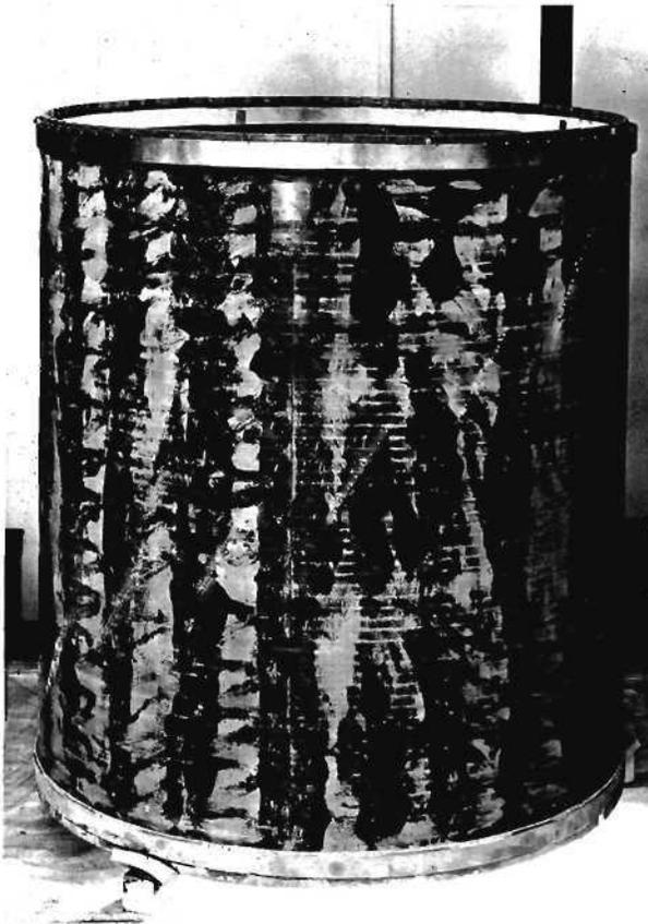
**Bild 28 :** Zylindrische Proportionalkammer, Länge 1.000 mm, Durchmesser 900 mm
