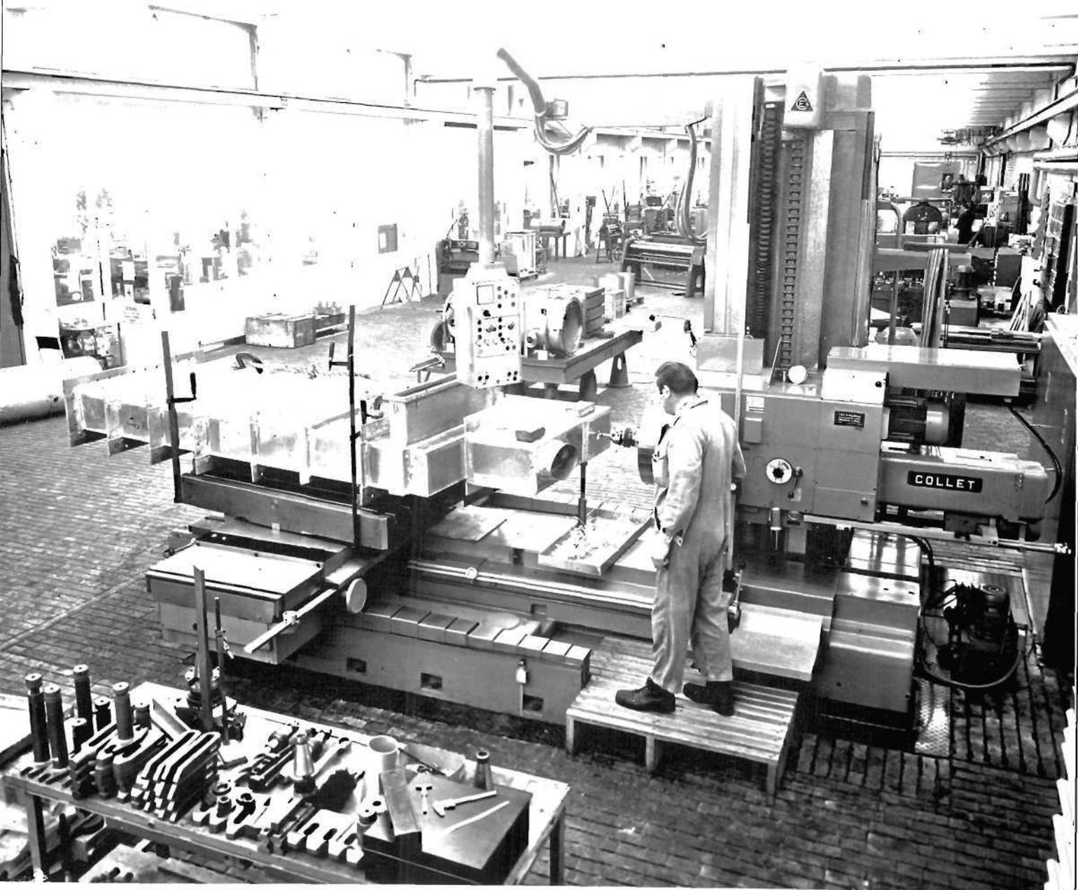
**Bild 85** : Bearbeitung einer Vakuumkammer in der Werkstatt
