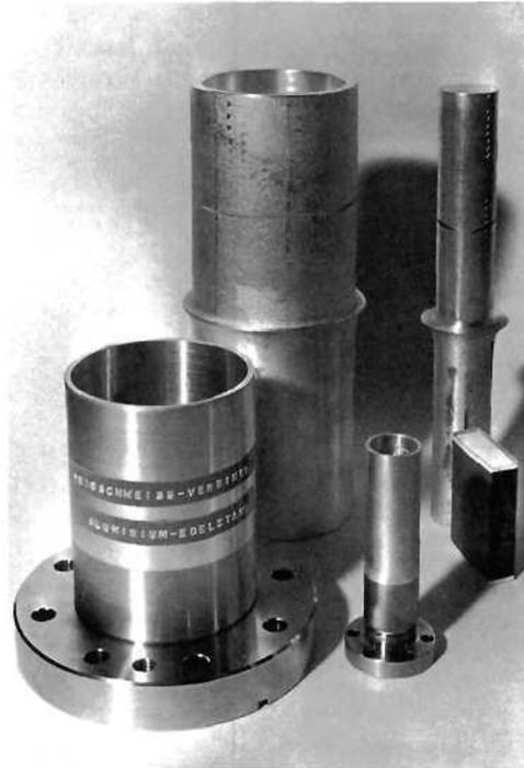
Abb. 90 Reibgeschweißte Aluminium-Edelstahl-Übergänge (REPI-Verfahren) (23932/15)
