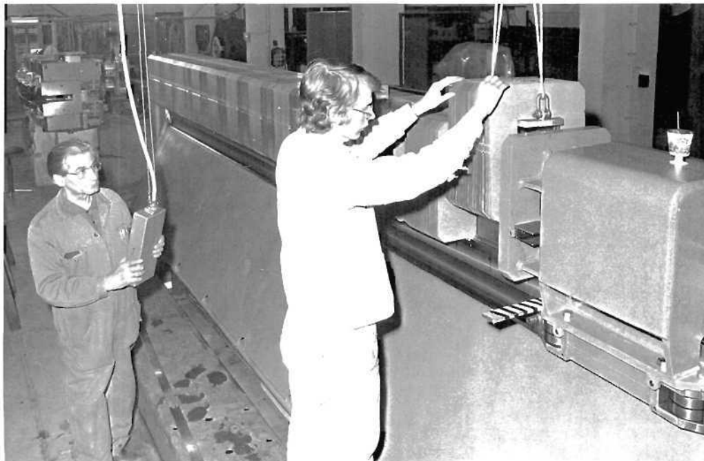
Abb. 86 Stapeln eines Dipoljoches
