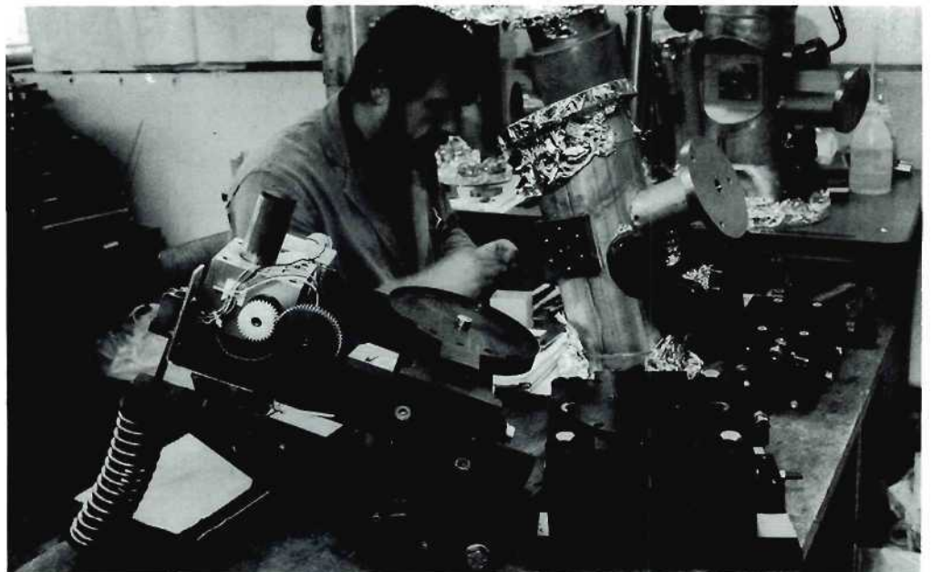
Abb. 85: Röntgenmonochromator für HASYLAB.
