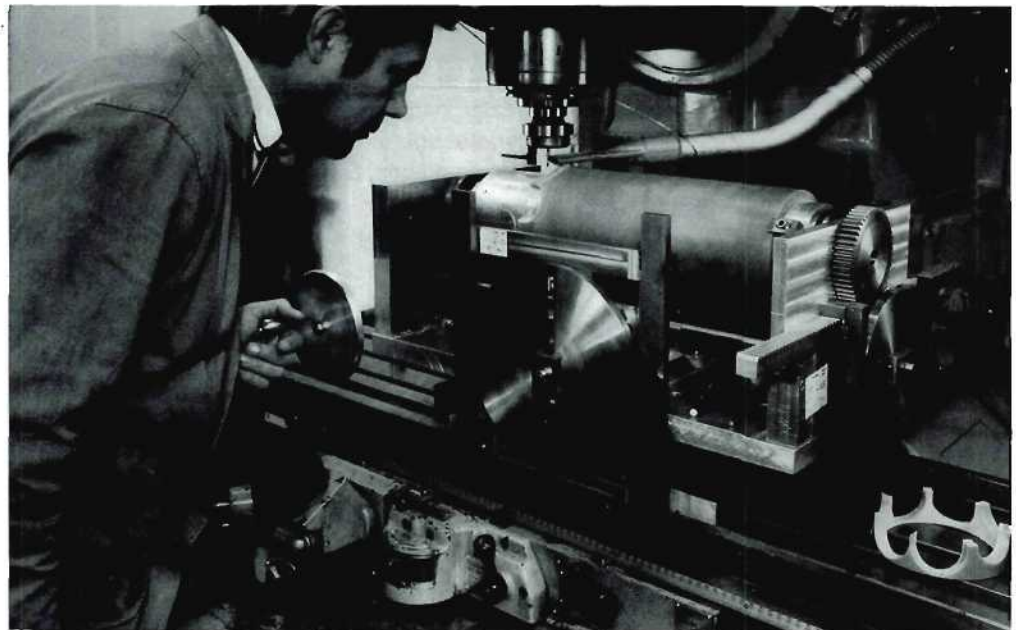
Abb. 83: Die dreidimensionale Fräsvorrichtung zur Herstellung von Abstandstücken für die Spulenköpfe.
