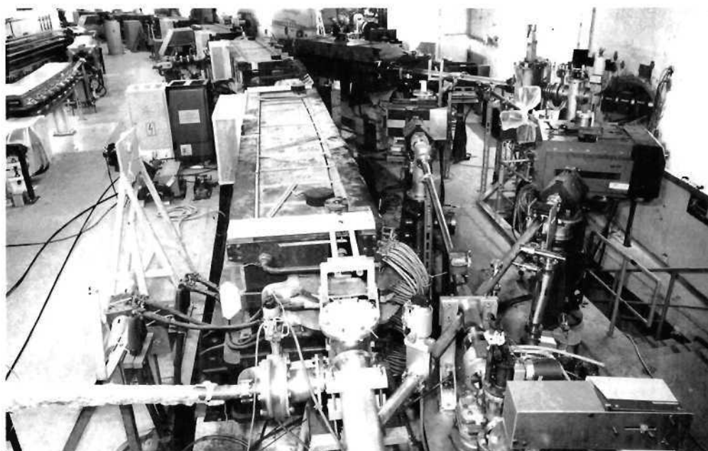
Abbildung 98: Strahltransport vom LINAC I zu DESY I und DESY II. (38380/35)
