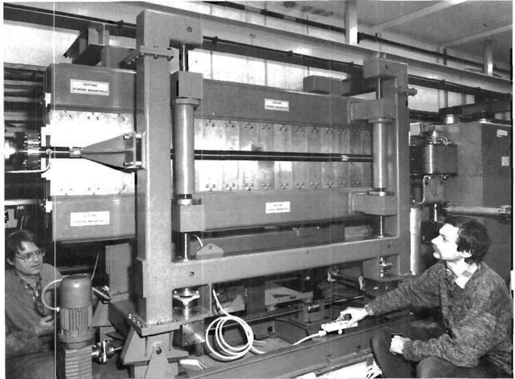
Abbildung 55: Der harte Röntgenwiggler HARWI nach dem Einbau in den Speicherring DORIS II. (40486/16)
