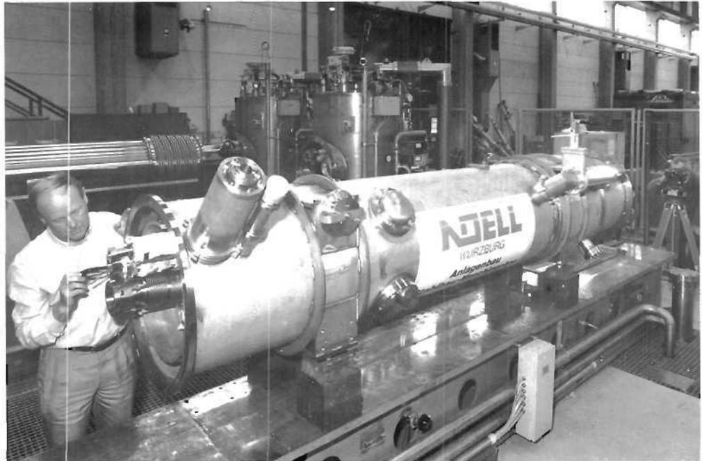
Abbildung 65: Das erste Vorserien-Exemplar aus der deutschen Produktion der supraleitenden Quadrupole. (40952/33)
