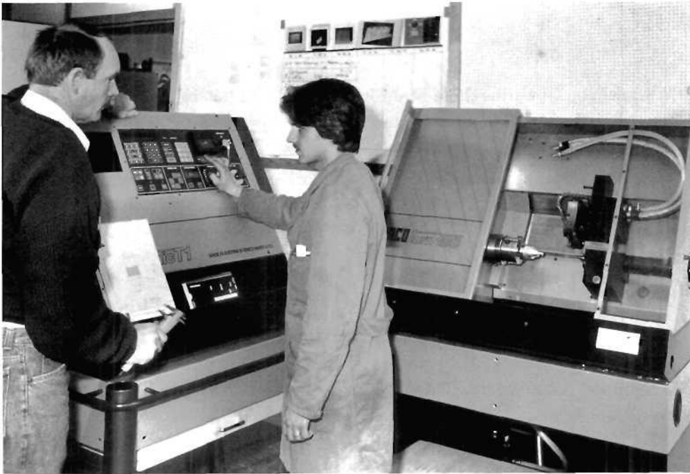
Abbildung 79: Die neue CNC-gesteuerte Drehmaschine für die Ausbildung in den Mechanik-Berufen. (41608)
