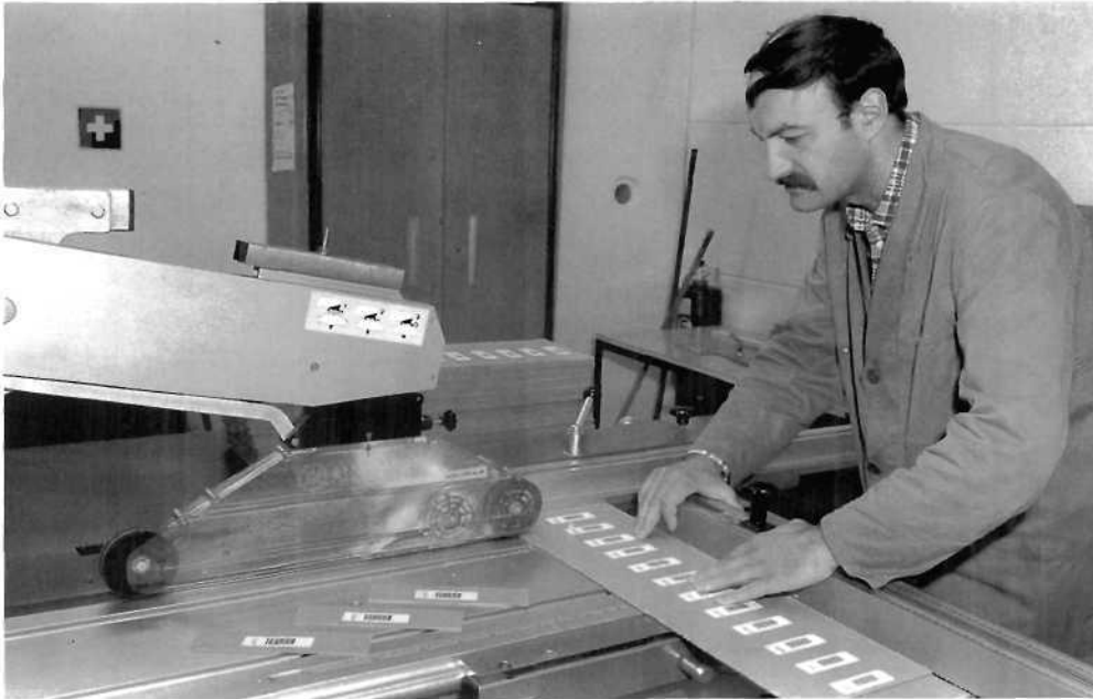
Abbildung 12: Zuschnitt von Szintillatorplatten für das Kalorimeter. Jede Platte ist nummeriert. (41496/20)
