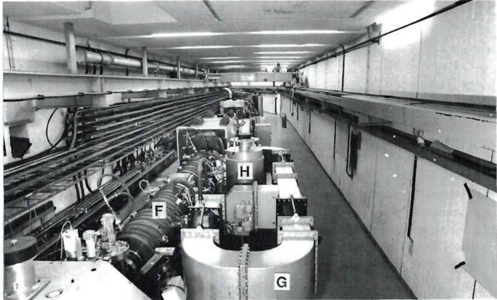
Abbildung 57: Cavities (F) in der Südhälfte von DORIS III mit Wellenleitern (G), die um DORIS-Ausrichtssäulen (H) herumgeführt sind. (422449/25)
