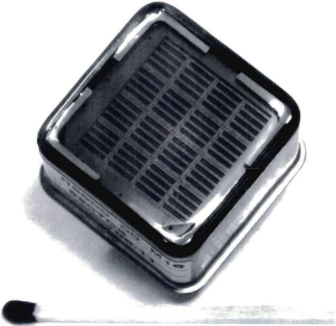
Abbildung 40: Vielanoden-Photovervielfacher (M16) für den Einsatz im HERA-B RICH-Detektor.
