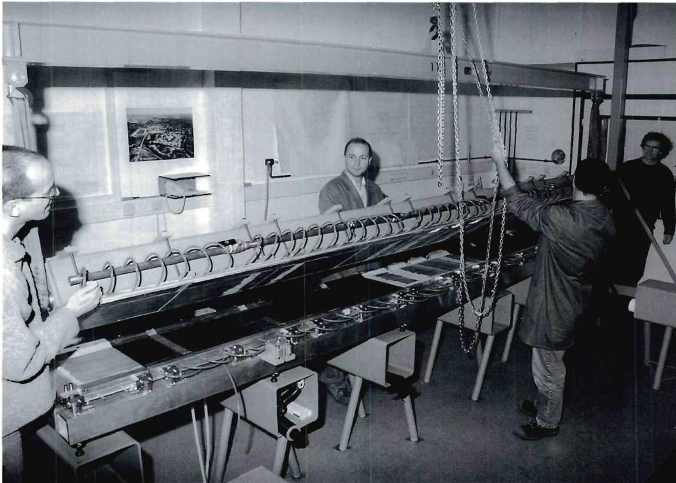
Abbildung 78: Fertigungsform für die äußeren Spurkammern von HERA-B.
