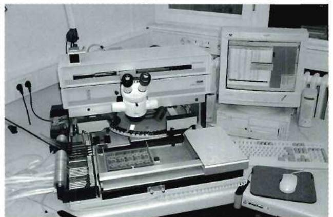
Abbildung 127: Bestückungsautomat (Halbautomat).
