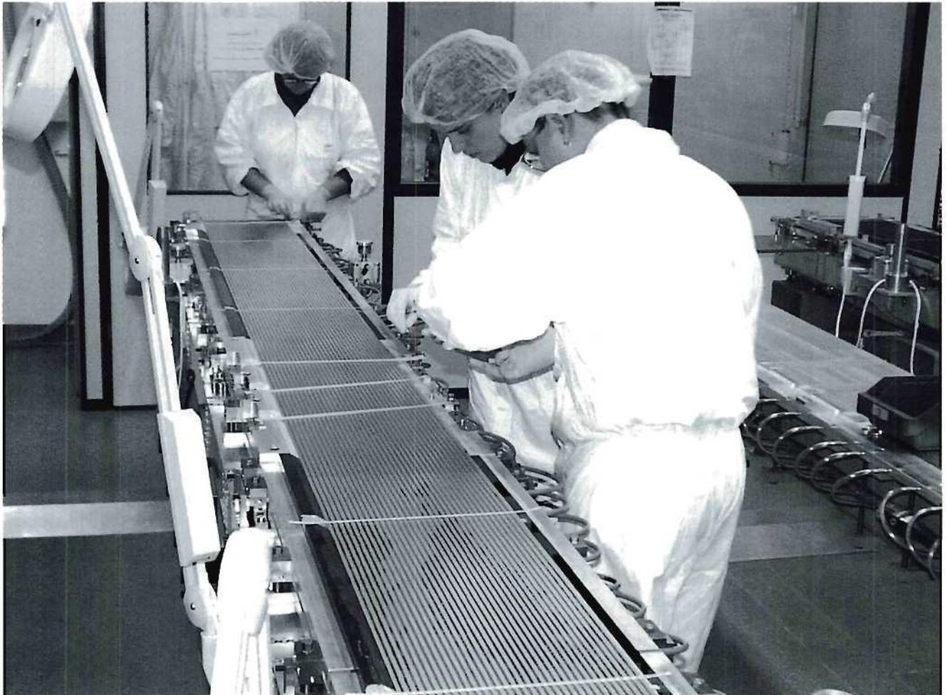
Abbildung 88: Montagearbeiten an einem TC-Modul.
