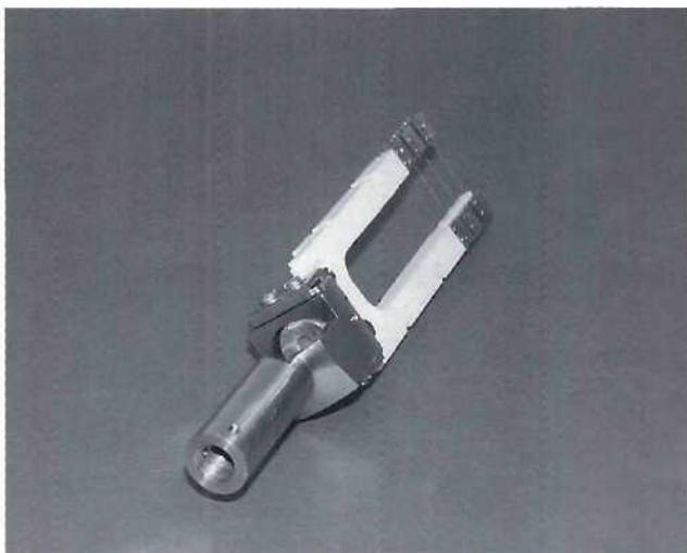
Abbildung 103: Gabel aus gasungsfreier Keramik für den Wirescanner.
