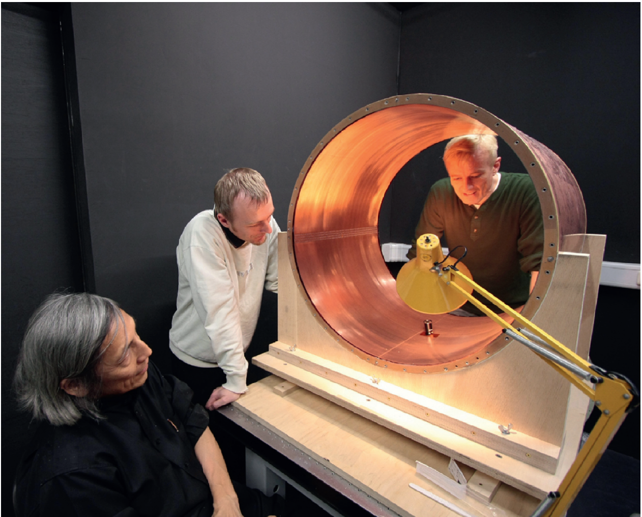
Abbildung 86: Photo des TPC-Feldkäfigs, unmittelbar nach der Fertigstellung, im geöffneten Zustand.
