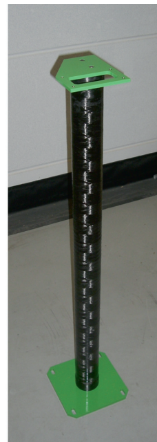
Abbildung 135: CFK-Stütze für das HF-Momo mit sehr geringem Wärmeausdehnungskoeffizienten.
