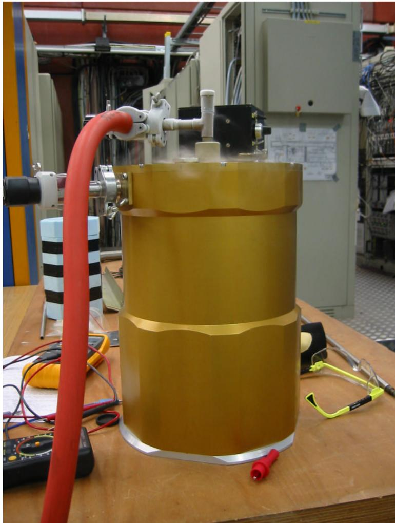
Abbildung 3.20: Foto des Bolometers vom Max-Planck-Instituts für Radioastronomie in Bonn. Flüssiger Stickstoff und flüssiges Helium werden von oben in den tonnenförmigen Kryostaten eingefüllt. Der Schlauch verbindet das Heliumbad mit einer Vakuumpumpe um den Druck auf 35 mbar zu senken. Die nachzuweisende Strahlung wird von unten in das Bolometer eingekoppelt. Die schwarze Box am hinteren Rand enthält zwei Vorverstärker und die batteriegespeiste Stromquelle für die Thermistoren.
